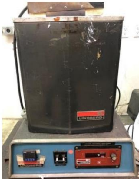
Figura 6. Horno vertical Lindberg empleado para la fundición de las aleaciones.
