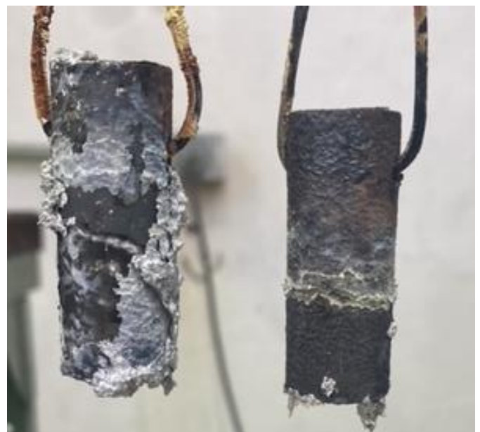
Figura 12. Debido a la consistencia granulosa (ver figura 3) del baño que se esperaba fuera líquido; éste no tenía buena adherencia a las probetas de acero 1018.
