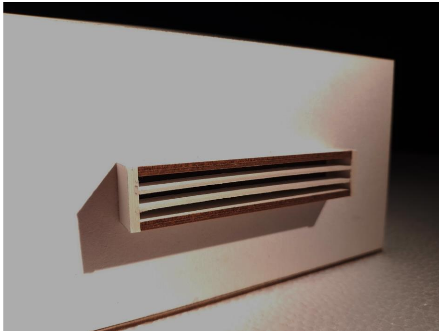
Fotografía 13 Penetración solar en fachada sur durante solsticio de invierno a las 9 am Fuente (Ramírez Iván, 2023)
