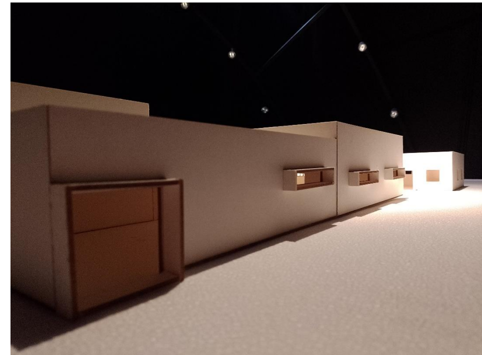
Fotografía 20 penetración solar en fachada norte durante solsticio de verano a las 12 pm Fuente (Ramírez Iván, 2023)
