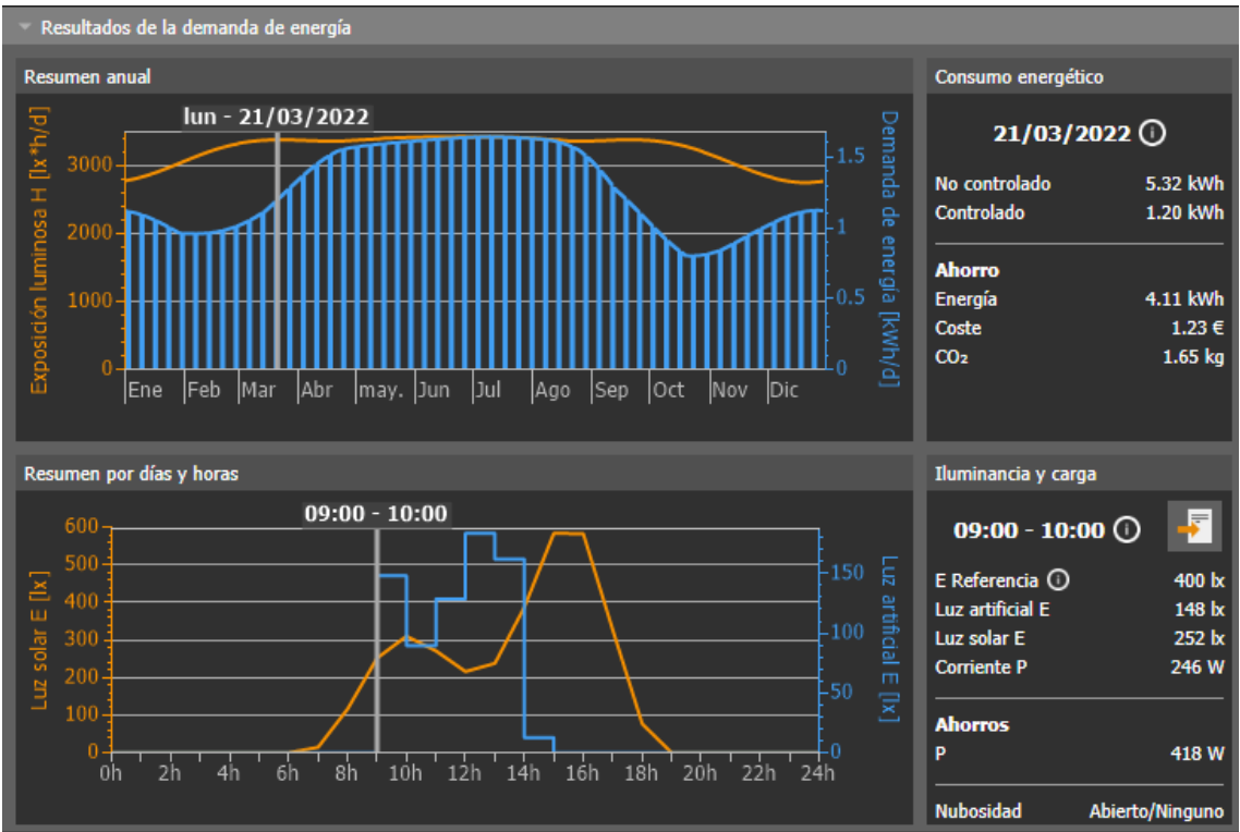
Gráfica 54: Niveles de iluminación natural y artificial en vestíbulo durante los equinoccios Fuente (DIALux evo, 2023)
