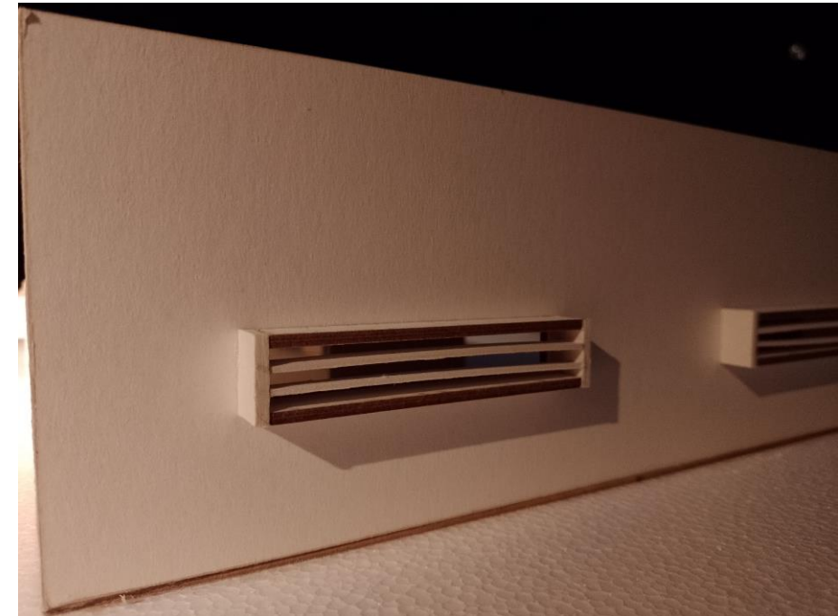
Fotografía 15 Penetración solar en fachada sur durante solsticio de invierno a las 5 pm Fuente (Ramírez Iván, 2023)
