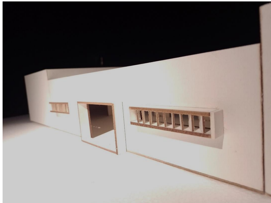
Fotografía 18 Penetración solar en fachada oeste durante solsticio de verano a las 2 pm Fuente (Ramírez Iván, 2023)
