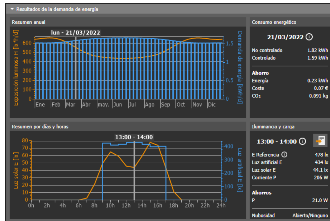
Gráfica 57: Niveles de iluminación natural y artificial en salas durante los equinoccios Fuente (DIALux evo, 2023)
