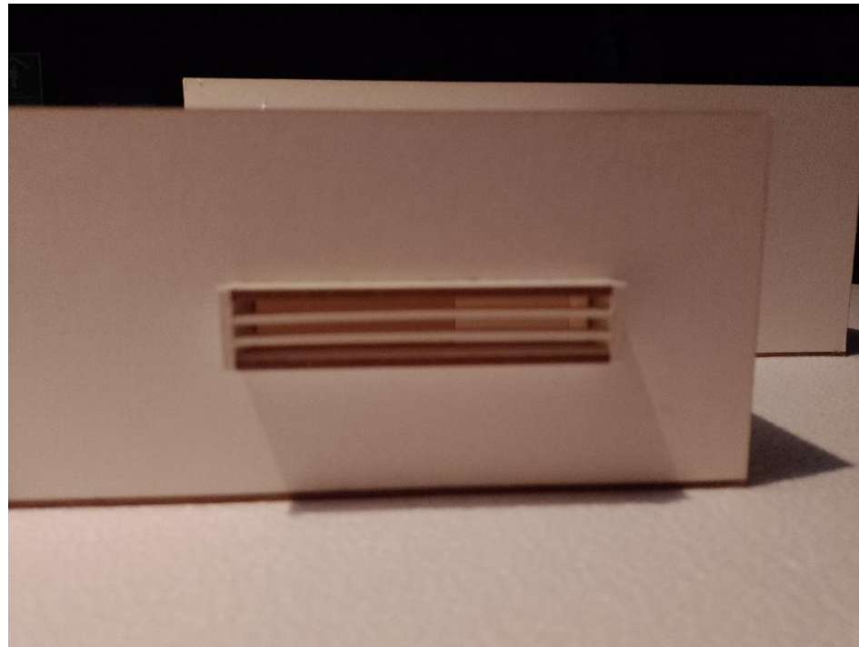
Fotografía 17 Penetración solar en fachada sur durante equinoccios a las 2 pm Fuente (Ramírez Iván, 2023)
