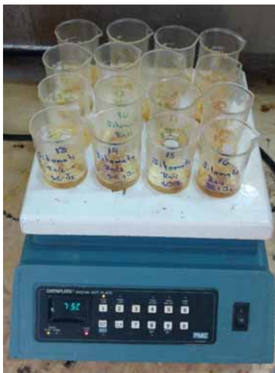
Figura 4.2 Digestión abierta de muestras vegetales
