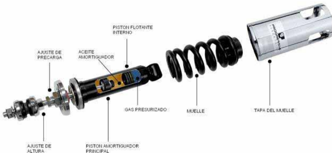
Figura 12. Conjunto Muelle-Amortiguador.
