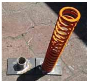
Figura 59. Soportes para los extremos del resorte
