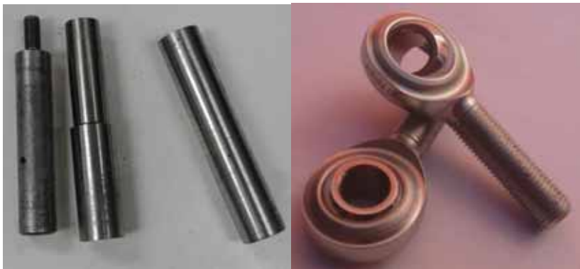
Figura 52. Ejes y rotulas reemplazados del sistema de dirección
