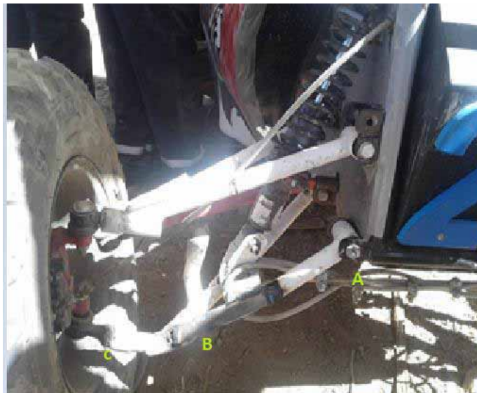
Figura 57. Falla en la tijera inferior durante la competencia
