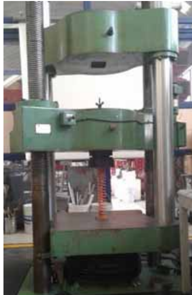
Figura 60. Resorte montado en la Máquina Universal de Ensayes
