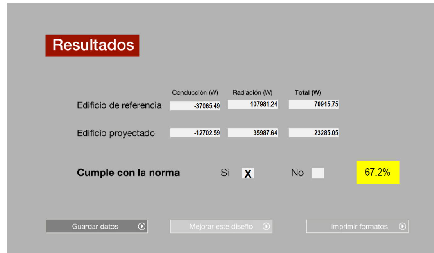
fig. 74 Herramienta de calculo NOM-008-ENER-2001- resultados de la envolvente
