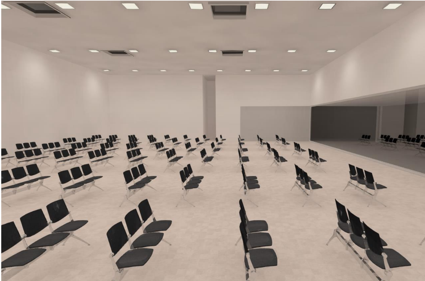
fig. 99 Sala de espera Iluminancia 200 lux, Imagen propia realizada en Dialux evo.
