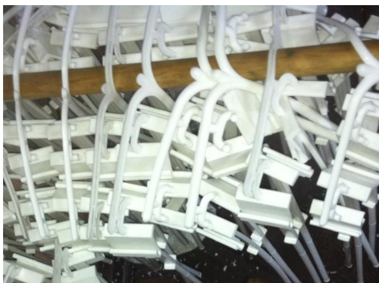
Figura 5.8 Rebaba de plástico de base de banderín
