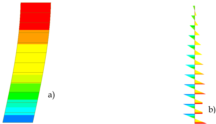
Figura 5.15 a) Deformada y diagrama de momentos de un muro empotrado en cada uno de sus de 12 pisos
