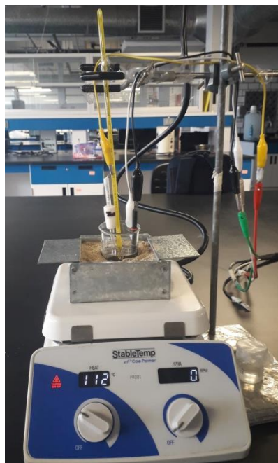
Figura 2.2. Montaje experimental de la celda electrolítica de tres electrodos con baño de arena para controlar la temperatura del electrodeposición
