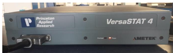
Figura 2.1. Fotografía del potenciostato-galvanostato VersaSTAT 4.
