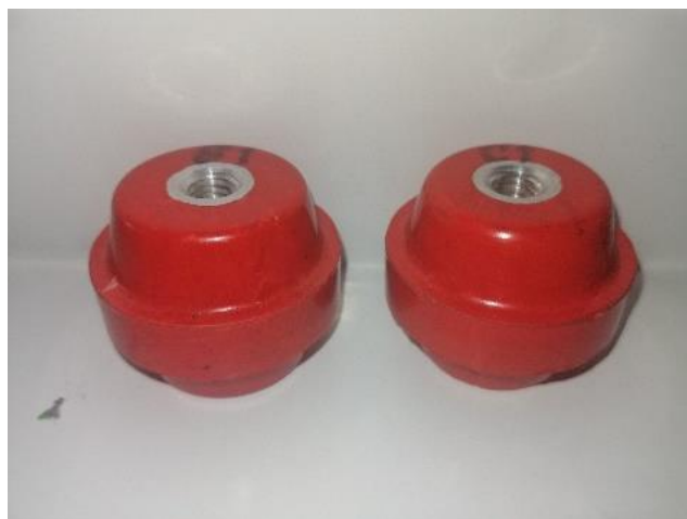
Figura 6. Piezas obtenidas por termocompresión para ensayos eléctrico y mecánicos.
