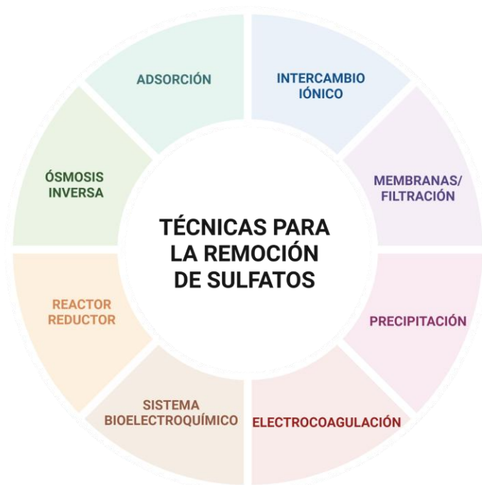
Figura 2. Esquema de los principales métodos de remoción de sulfatos
