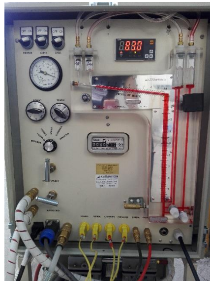
Figura 10. Consola del muestreador isocinético, Marca Seelin, Modelo FF-0012, Serie 0024
