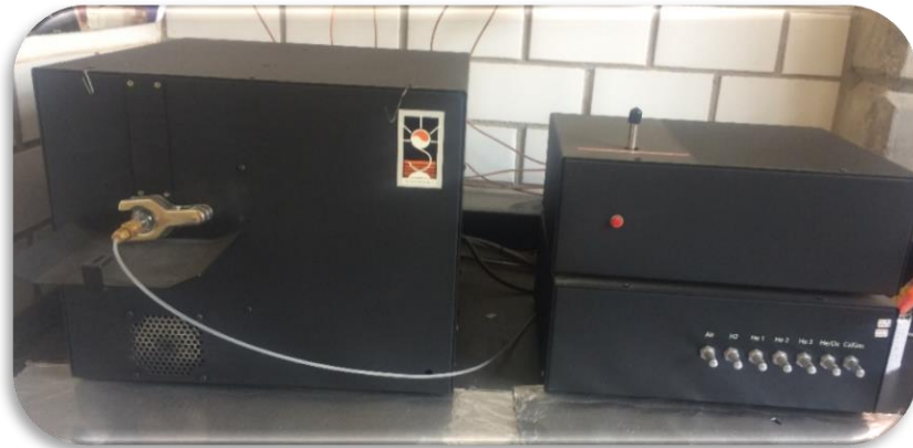
Figura 14. Analizador de carbono elemental y carbono orgánico modelo Sunset Laboratory
