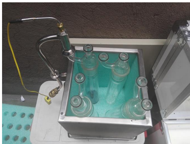
Figura 12. Caja fría con impactadores
