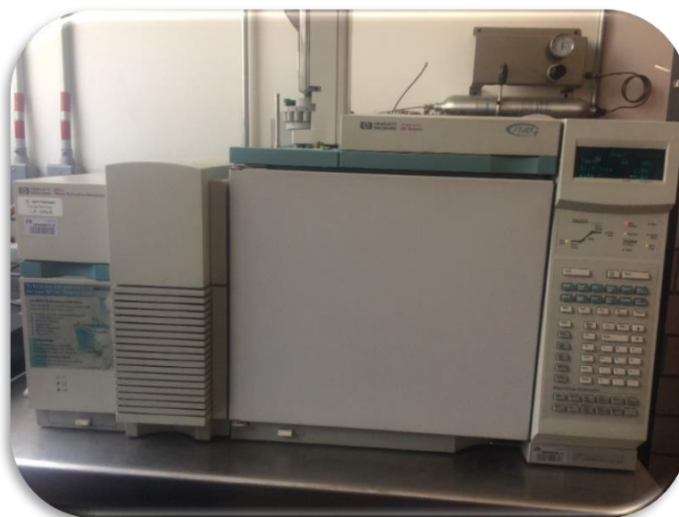
Figura 19. Cromatógrafo de gases modelo 6890 plus acoplado a un espectrómetro de masas HP 5973
