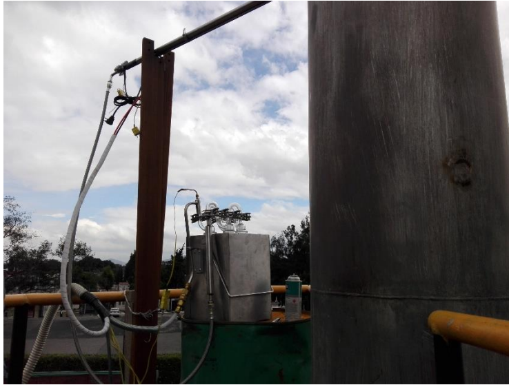
Figura 4. Fotografía del tren de muestreo isocinético
