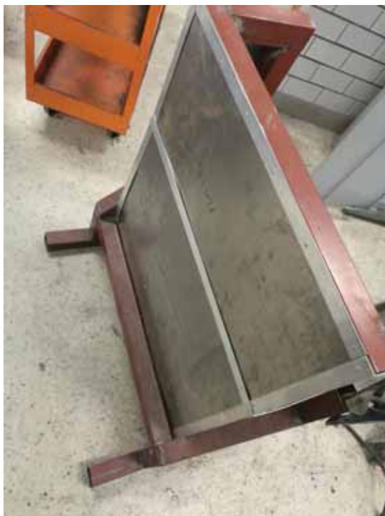
Fotografía 37.- Colocación y fijación de lámina cal 20 y las molduras del banco de trabajo.
