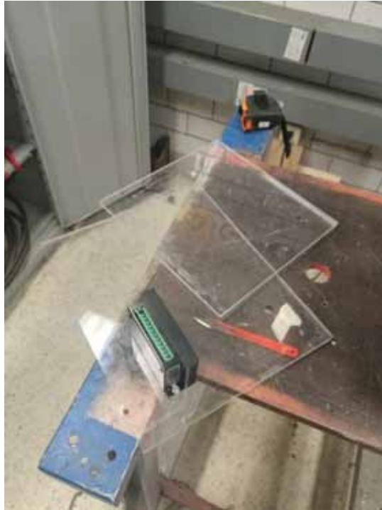
Fotografía 75.-Trazado de los diferentes barrenos para la colocación de los dispositivos de control.
