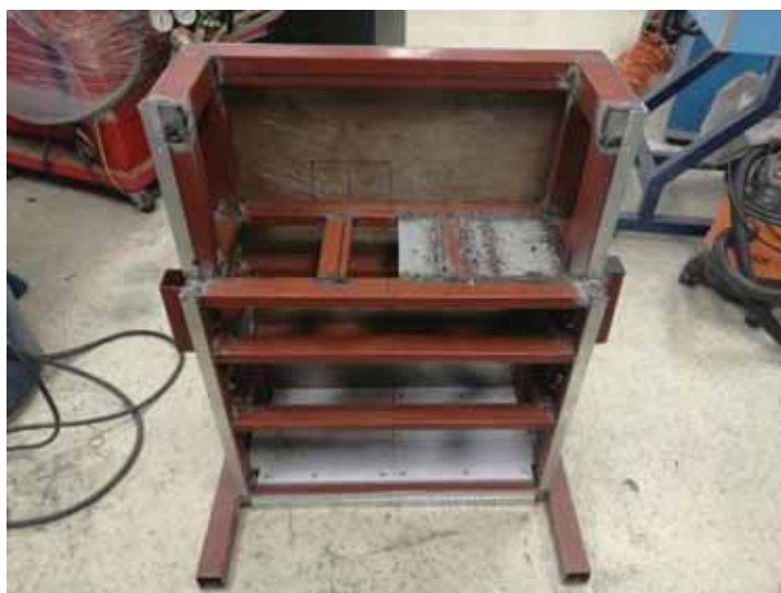
Fotografía 40.- Vista frontal de los últimos detalles de soldadura y pasada con pulidora.
