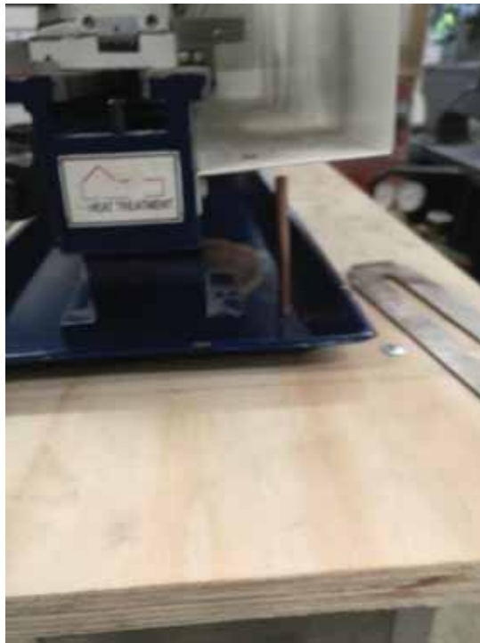
Fotografía 20.- Colocación del tubo de cobre de 1/4" en el sistema.
