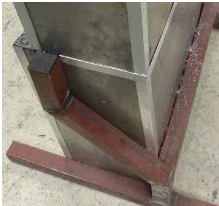
Fotografía 38.- Colocación del tapón de plástico cuadrado de 2" x 2".
