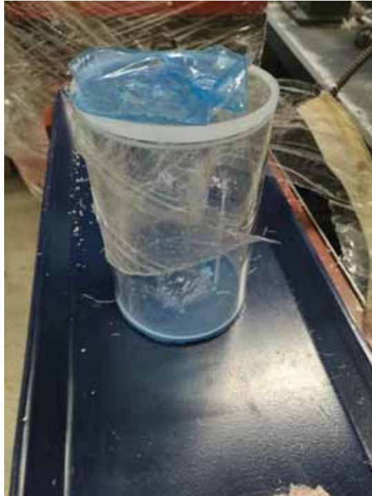
Fotografía 13.- Ensamble del cilindro con las dos tapas ya ajustadas.
