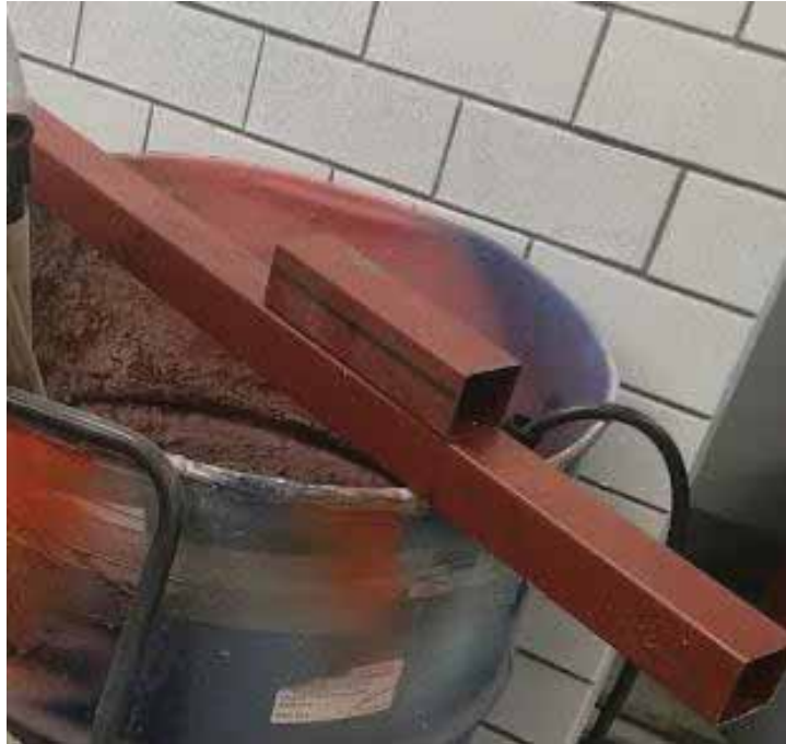
Fotografía 29. Tubular cuadrado de 2"x2" cortado, listo para soldar.
