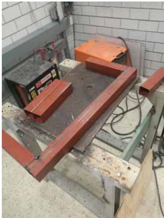
Fotografía 30. Proceso de armado de la estructura del banco.
