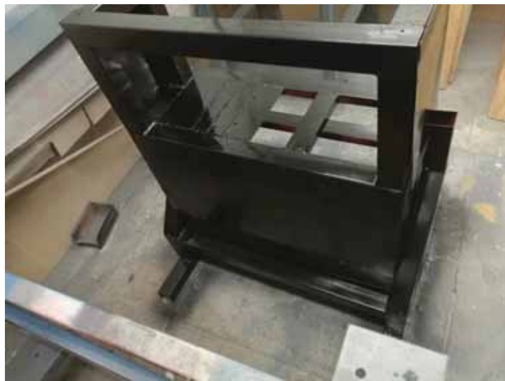
Fotografía 54.- Vista de la parte de atrás del banco acabado en pintura negra, aplicado en la cámara de pintura dentro del laboratorio de desarrollo de nuevas tecnologías.
