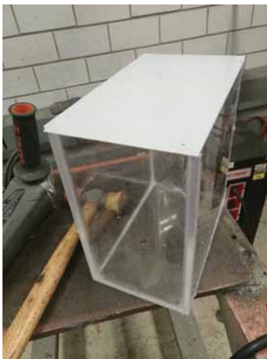
Fotografía 6.- Deposito del refrigerante ya conformado y listo para su colocación.
