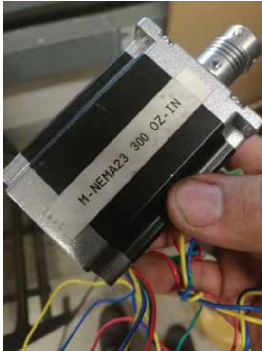
Fotografía 63.- Servomotor utilizado para la transmisión de potencia.
