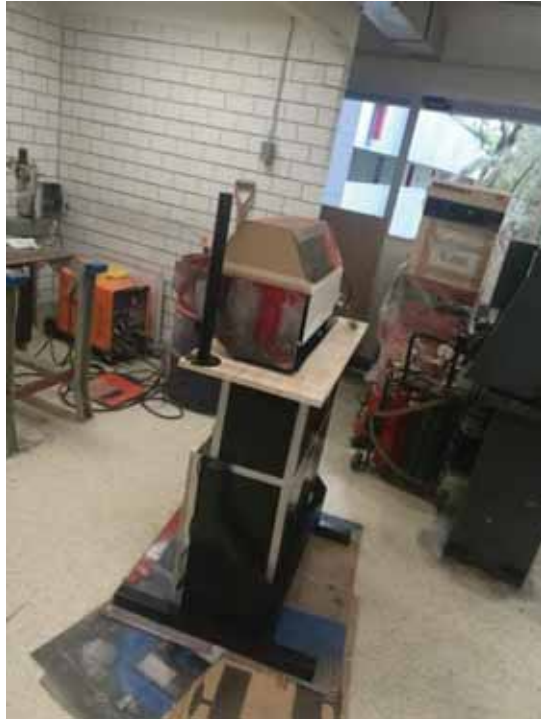
Fotografía 81. Vista lateral de la protección que encajona el torno para proteger de las salpicaduras.
