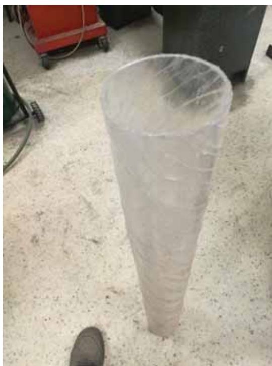
Fotografía 8.- Tubo de acrílico de 4" utilizado para la elaboración del filtro.
