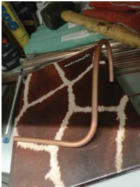
Fotografía 22.- Tubo de cobre de 1/4" doblado que suministrara el líquido refrigerante.
