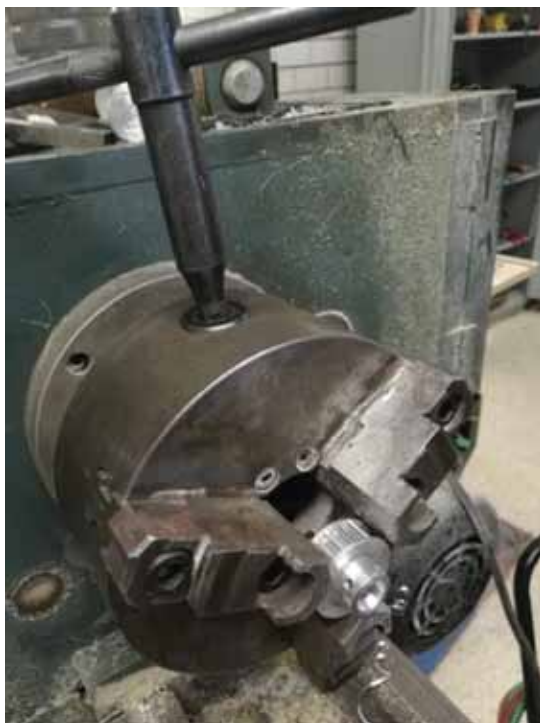
Fotografía 71.- Aumento de diámetro de agujero de la polea.
