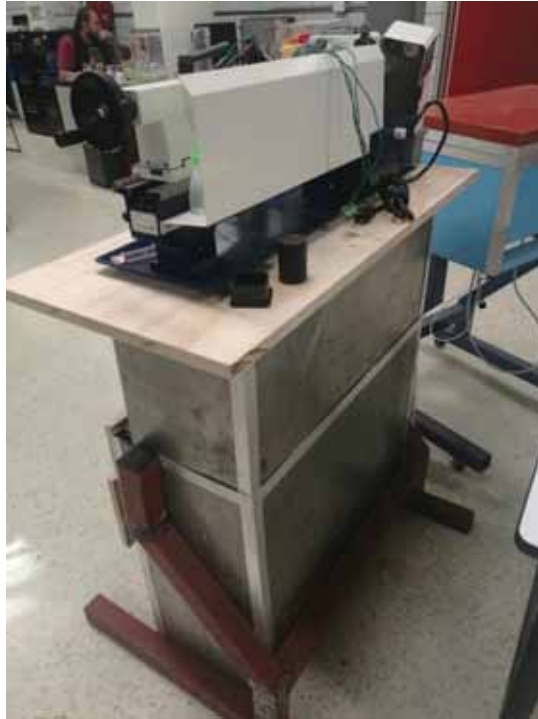
Fotografía 33. Trazado y colocación del torno en la mesa de trabajo.
