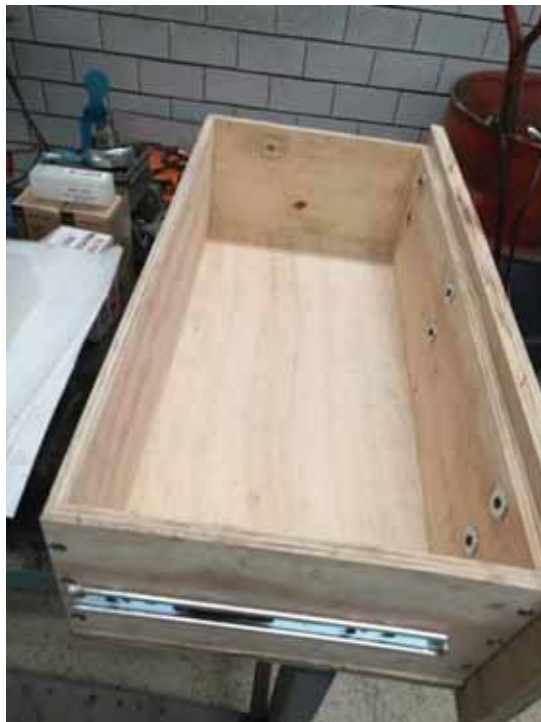
Fotografía 46.- Gaveta de en medio, armado con pijas de 1/4"x3/4".
