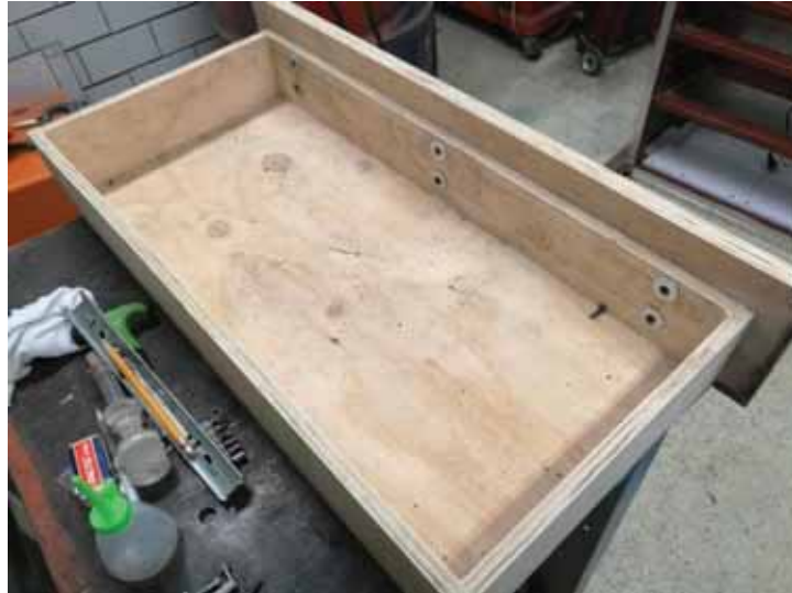
Fotografía 43.- Gaveta superior ensamblado de triplay de 12mm y 18mm.
