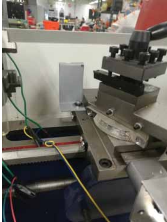
Fotografía 21.- Placa de soporte para el tubo curvo.
