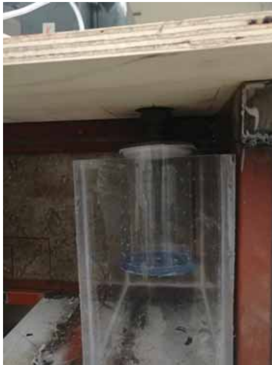
Fotografía 18.- Instalación del depósito y del filtro dentro del banco de trabajo para su prueba de funcionamiento.
