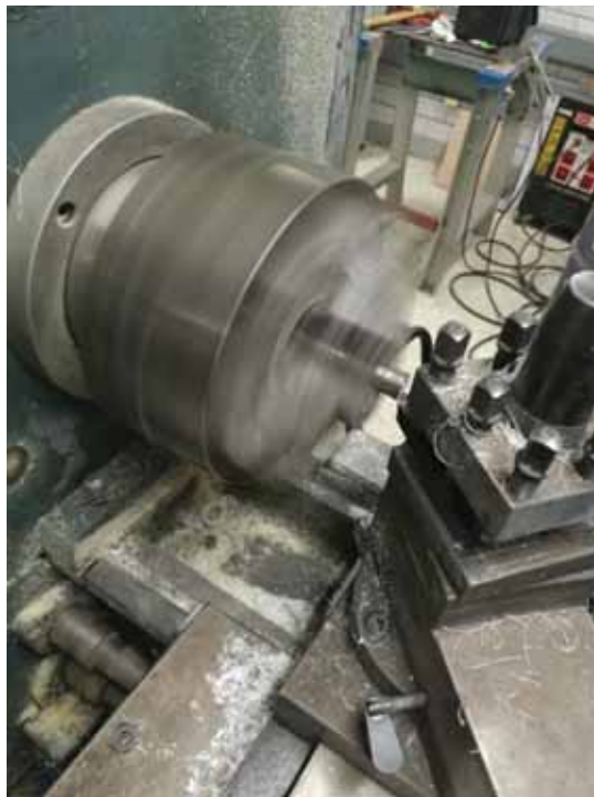
Fotografía 70.- Fabricación de una extensión de eje para la correcta posición de la polea.
