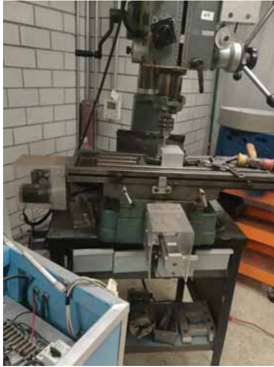
Fotografía 67.- Desbastado de las correderas en la fresadora CNC.
