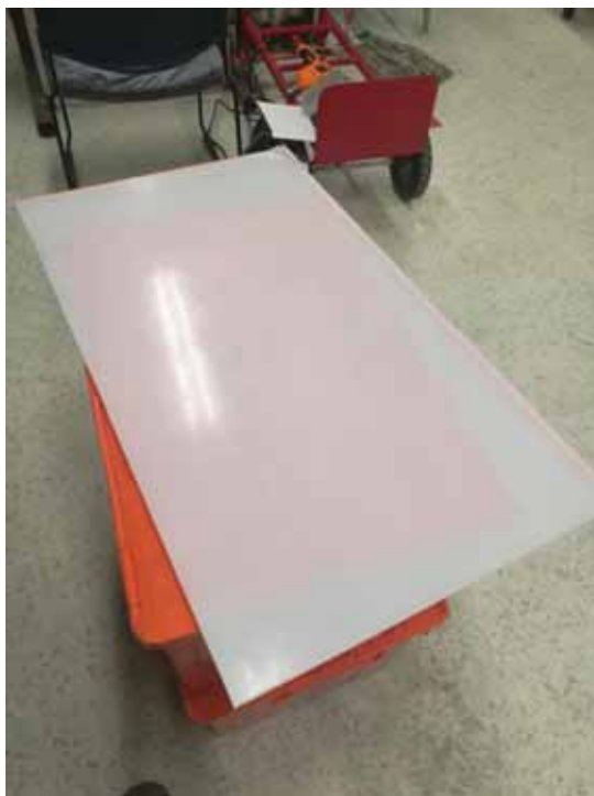
Fotografía 5.- Acrílico de 6mm utilizado para el armado del depósito del refrigerante y la caja de controles.
