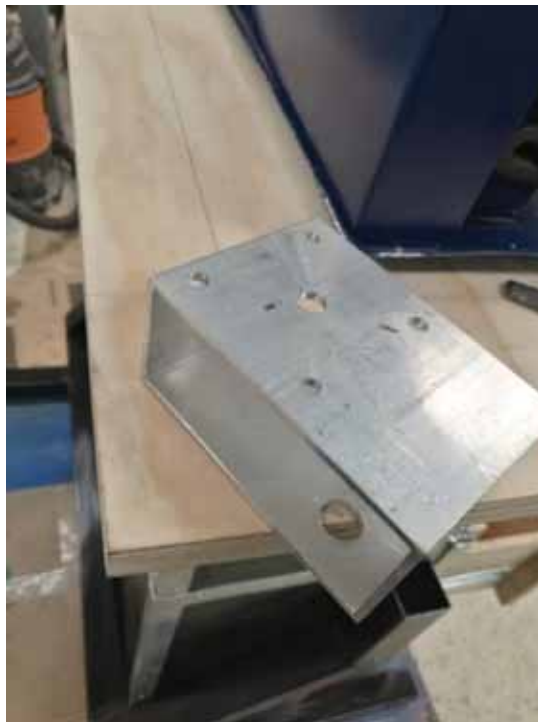
Fotografía 66.- Trazado y barrenos para las correderas en el ajuste de tensión.
