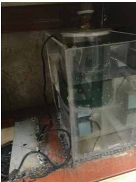
Fotografía 27.-Pruebas de funcionamiento del circuito cerrado con agua, para comprobación de resultados y fugas (a \frac{3}{4} de su capacidad).
