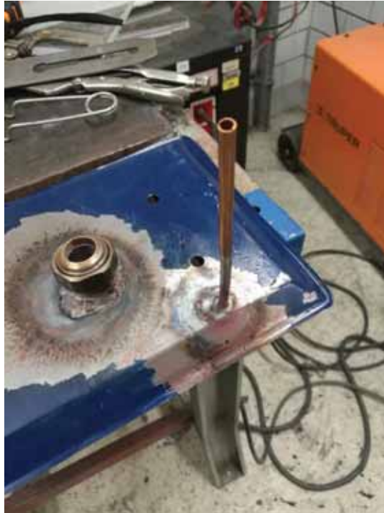
Fotografía 23.- Soldado de tubo de cobre de 1/4" a la base del torno.
