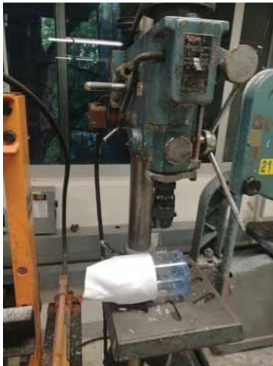
Fotografía 14.- Perforación del tubo de acrílico con broca de 3mm en el taladro de banco.
