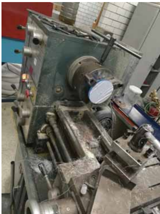
Fotografía 11.- Maquinado de las tapas del filtro en el torno paralelo.
