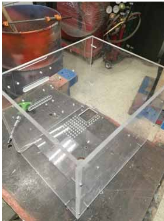
Fotografía 76.- Ensamblado de la caja de acrílico para los diferentes dispositivos de control.
