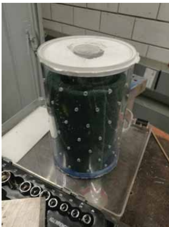
Fotografía 26.- Filtro totalmente ensamblado con boca de entrada roscada de 3/4" NPT.
