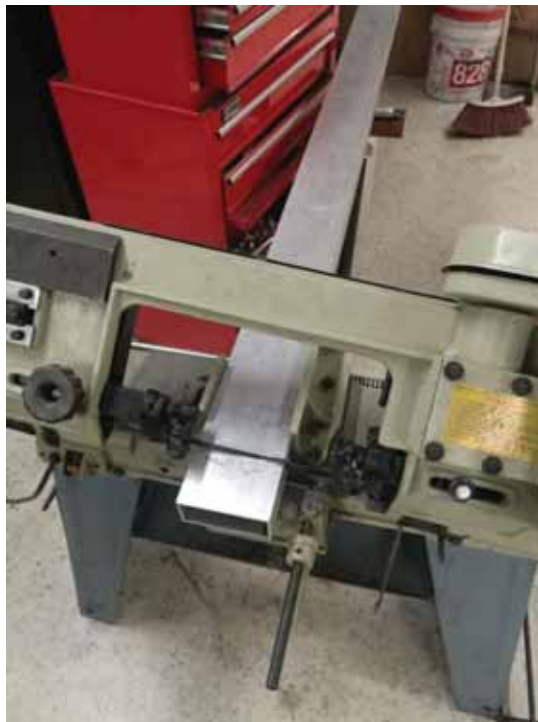
Fotografía 64.- Corte de la sección de perfil de 4"x1 3/4" en la sierra cinta horizontal.
