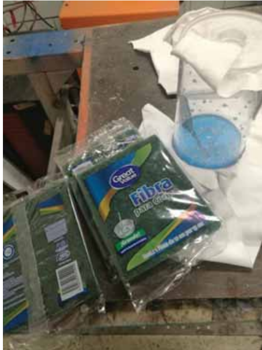
Fotografía 15.- Cilindro de acrílico maquinado y perforado, y fibras utilizadas para filtrar el refrigerante.
