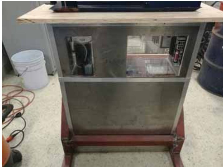
Fotografía 50.- Vista de la parte de atrás del banco con la colocación de la caja de control y el depósito del refrigerante.
