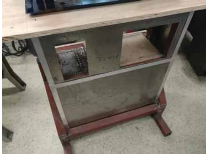
Fotografía 49.- Saques realizados a la lámina de cal 20 para obtener una visión en el interior del banco por la parte de atrás.
