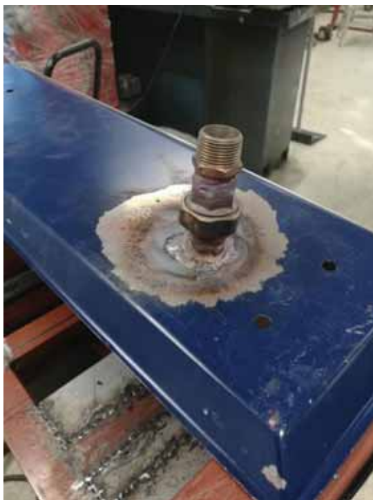
Fotografía 7.- Conexión de tuerca unión y conector macho de 3/4".
