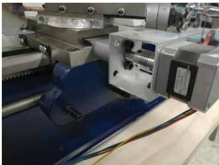
Fotografía 62.- Soporte de servomotor fabricado en perfil cuadrado de aluminio de 2"x2".
