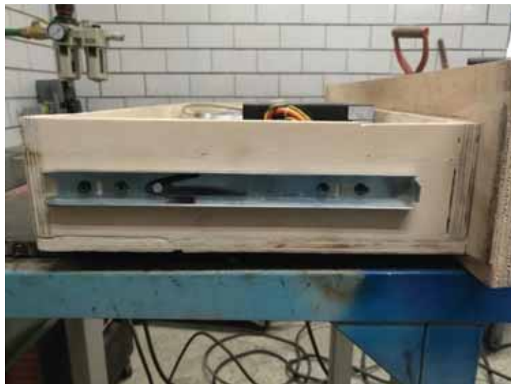
Fotografía 44.- Colocación de correderas de extensión de 25cm en la parte lateral de los cajones
