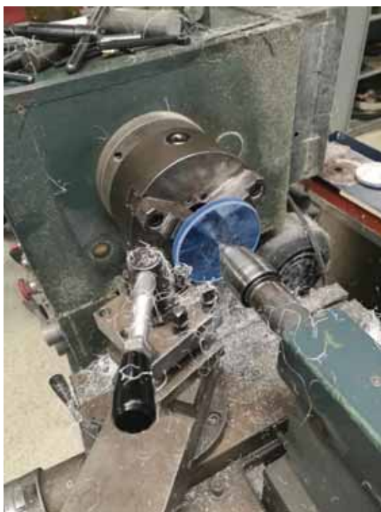
Fotografía 12.- Acabado del cilindrado con diámetro para obtener un ajuste con apriete.
