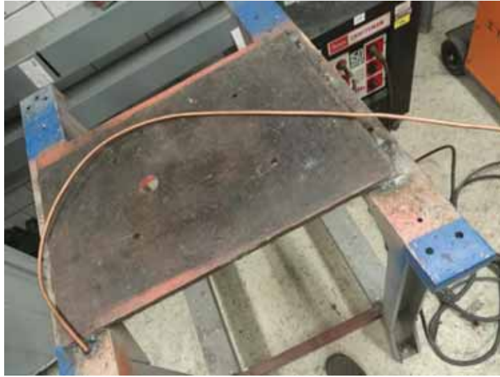
Fotografía 19.- Tubo de cobre flexible de 1/4" utilizado para el circuito del refrigerante.
