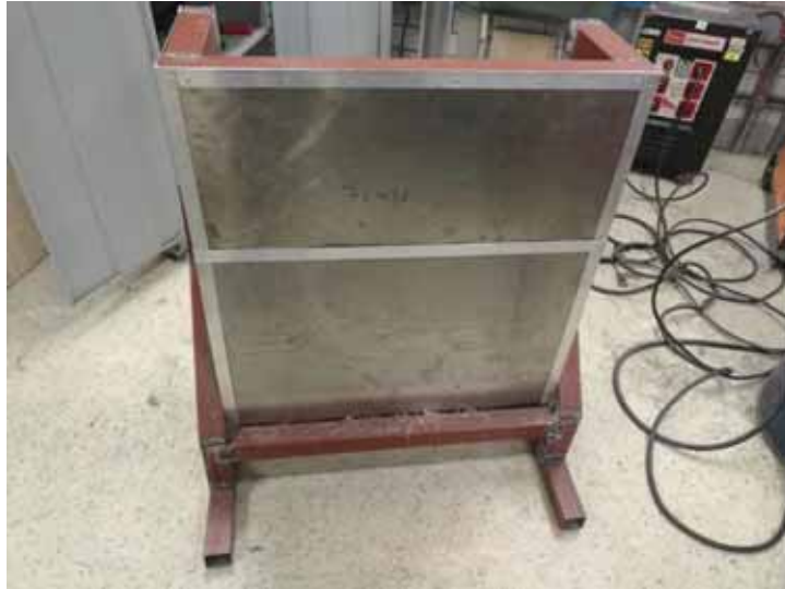
Fotografía 41.- Vista trasera de la colocación de lámina cal 20, ángulos y soleras de aluminio de 1".
