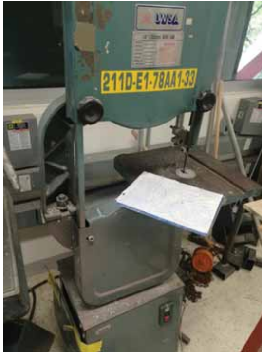
Fotografía 9.- Placa de acrílico de 9mm, cortada en la sierra cinta vertical, para aproximar la circunferencia de 4" de diámetro, que servirán como las tapas del filtro.
