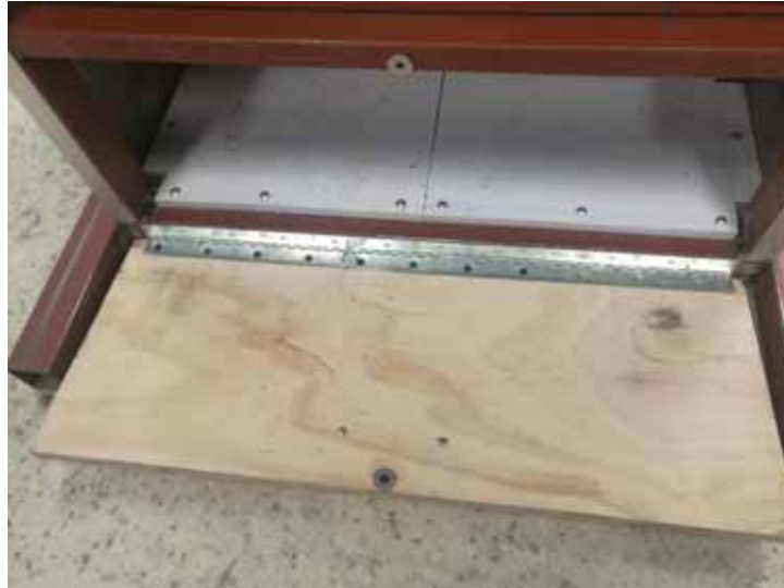
Fotografía 51.- Fijación del imán de 1.25in con una pija de ¼" x ½" a la compuerta.
