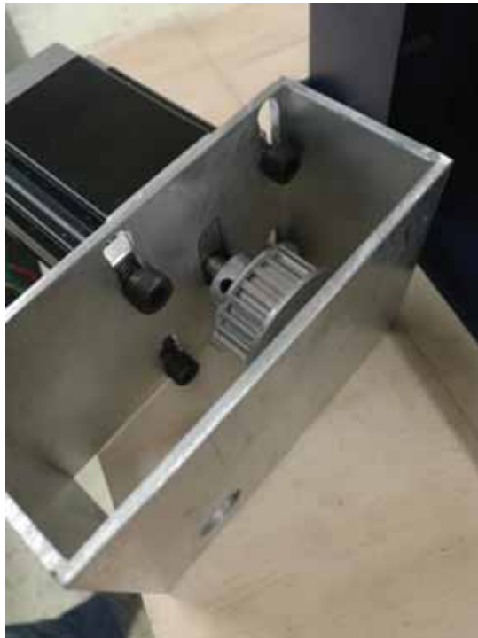
Fotografía 68.- Prueba de funcionalidad del recorrido del servomotor en las correderas.
