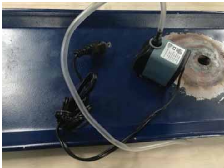
Fotografía 16.- Bomba seleccionada aqua-sub, con potencia de 8W, suficiente para elevar 1.2m la altura del refrigerante.
