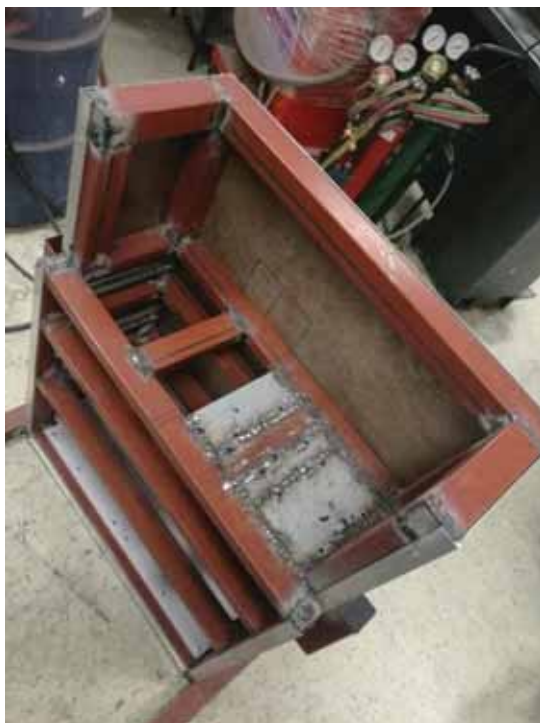
Fotografía 39.- Soldado de tapones de lámina cal. 12.
