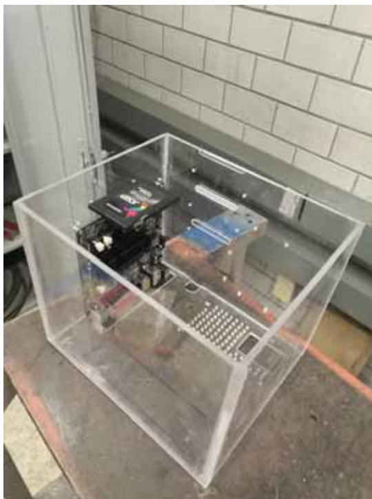
Fotografía 61.- Caja de acrílico de 6mm para proteger los controles.
