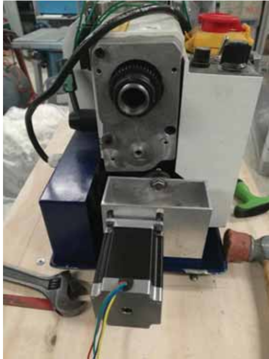
Fotografía 69.- Anclaje del servomotor.
