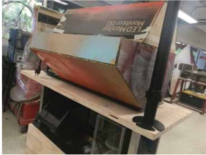
Fotografía 79.- Tolda para contener el líquido refrigerante.
