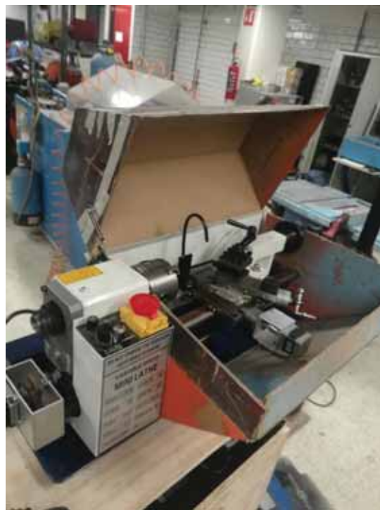
Fotografía 80.- Prueba de funcionalidad del prototipo, el cual se pretendía realizar con acrílico de 6mm de espesor.
