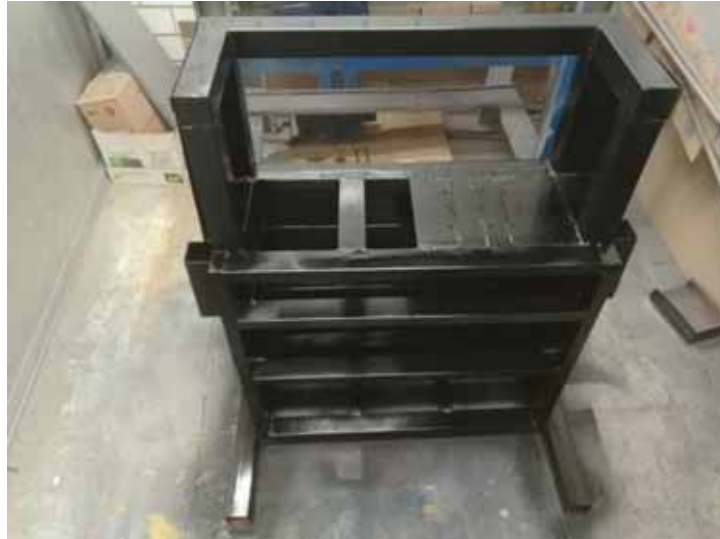
Fotografía 53.- Aplicación del esmalte negro en la estructura del banco de trabajo.
