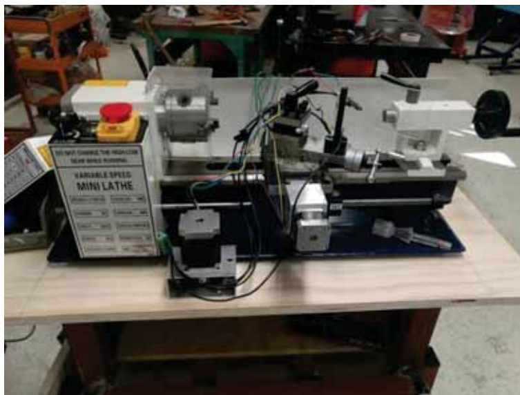
Fotografía 60.- Pruebas de funcionamiento en servomotores.
