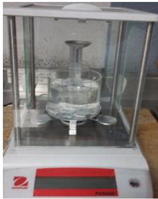
Fig. 6. Pesaje de las pastillas inmersas en agua con ayuda de una balanza analítica de densidades
