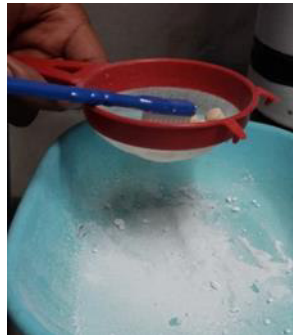
Fig. 2. Extracción de polvos del molino y de los elementos de molienda.
