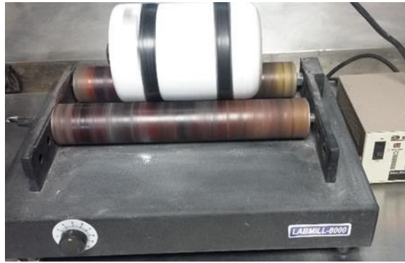
Fig. 1. Proceso de molienda de los polvos en sus distintas composiciones, con elementos de zirconia.
