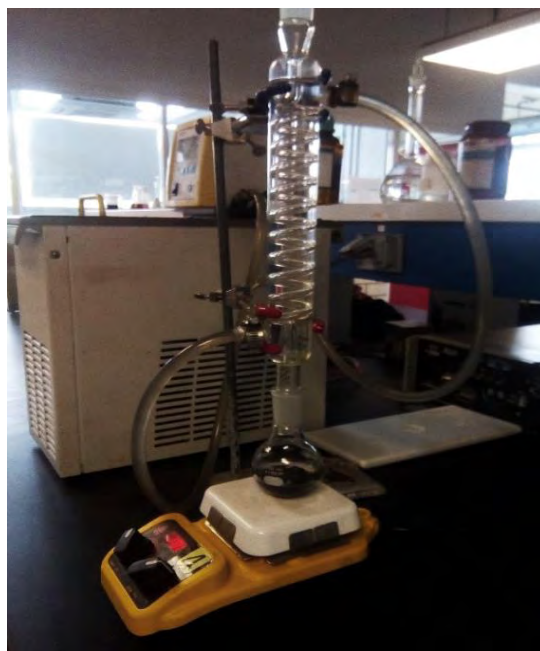
Figura 6. Instalación del recirculador hacia la celda: se lixivió 1.5 g de Ag_2O y 30 mL de DES, temperatura en el recirculador de 10\text{ }^\circ\text{C} , a 100 rpm.
