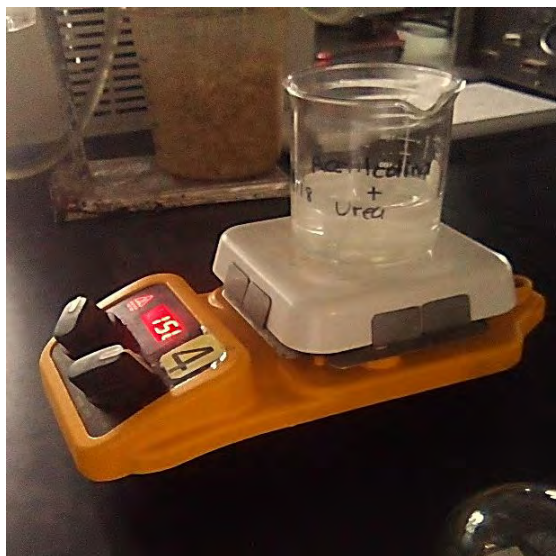
Figura 5. DES compuesto por: cloruro de acetilcolina ( C_7H_{16}ClNO_2 , >99%, Sigma-Aldrich) y Urea ( CH_4N_2O , 99%, Sigma-Aldrich), durante 4 h a 90\text{ }^\circ\text{C} .
