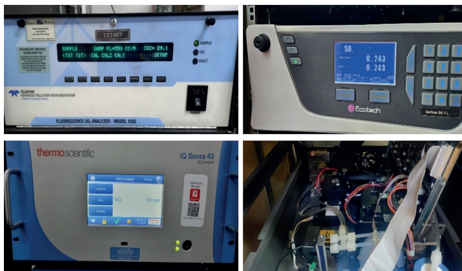
Figura 2.5 Diferentes marcas de analizadores automáticos de SO_2 e interior de un analizador (Fotografía: R. Castañeda).
