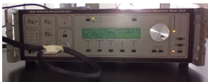
Figura 9. Potenciostato-galvanostato PAR 263A.
