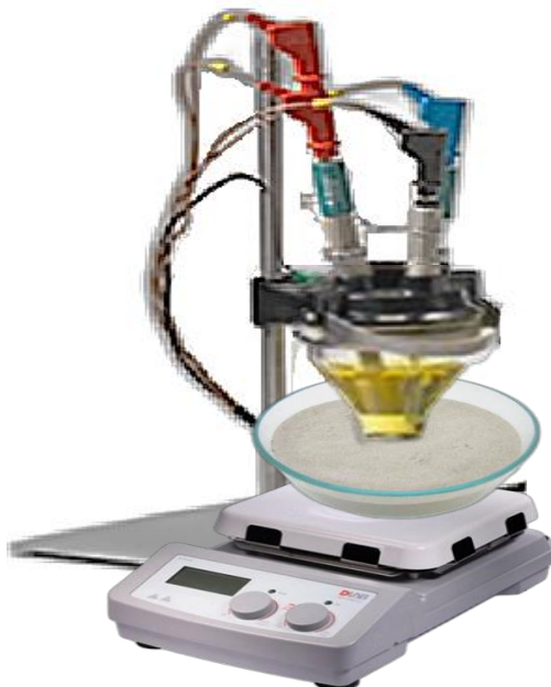
Figura 4. Celda electroquímica de tres electrodos o de corazón, conformada por el electrodo de plata (ER), el electrodo de carbono vítreo (ET) y el contraelectrodo de platino (CE), inmersos en el DES de \text{ChCl}:\text{U} (1:2 M) colocada sobre una parrilla eléctrica para mantener una temperatura de 70 °C.
