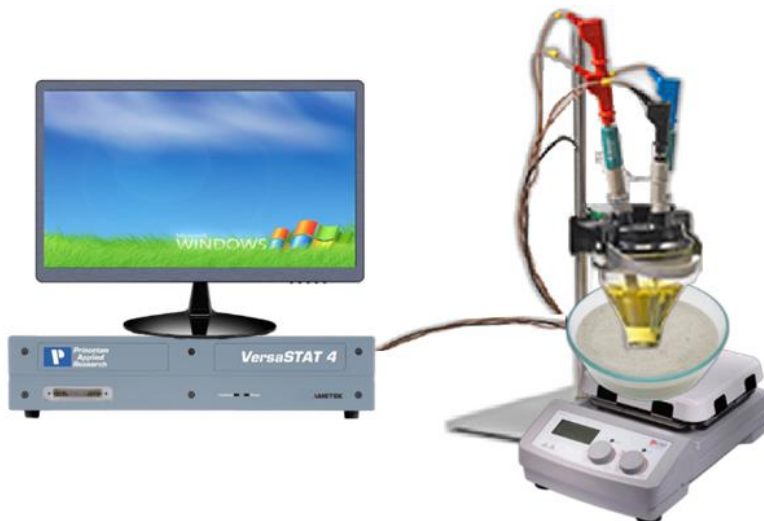
Figura 8. Sistema de la celda electroquímica conectada al potenciostato-galvanostato VERSASTAT y a una computadora.
