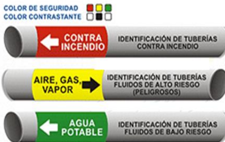
Figura 6.12. Identificación de la tubería (Fuente: Capacitación sobre la correcta interpretación de los elementos de señalización del centro de trabajo).
