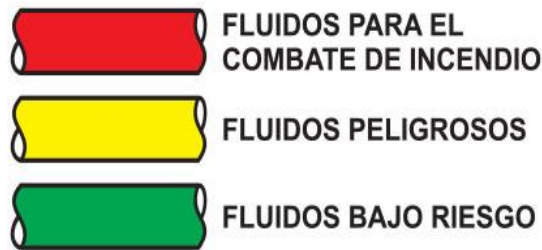
Figura 6.11. Código de colores para tuberías NOM-026-STPS-2008. (Fuente: Capacitación sobre la correcta interpretación de los elementos de señalización del centro de trabajo).
