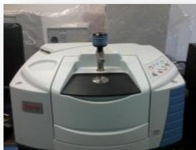
Figura 4.5. Espectrofotómetro IR, ThermoScientific modelo iS10.
