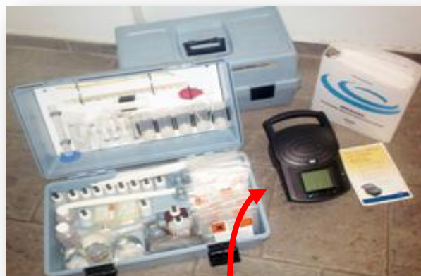
b) Espectrofotómetro de luz visible DR/2400 de Hach DR/2400
