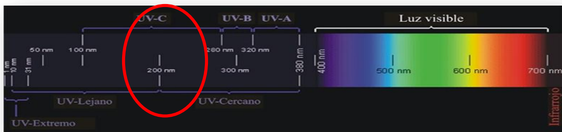
Figura 3.7. Espectro de radiación electromagnética. En el círculo rojo se encuentra la región UVC, radiación que produce el mayor efecto germicida.
