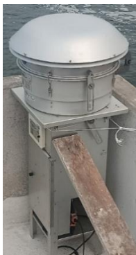
Figura 11. Muestreador de alto volumen (lado izquierdo) y muestreador ARA (lado derecho), utilizados en la recolección de muestras. Elaboración propia.
