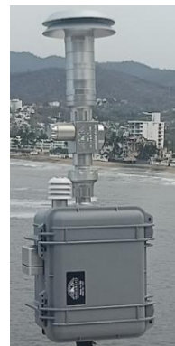
Figura 11. Muestreador de alto volumen (lado izquierdo) y muestreador ARA (lado derecho), utilizados en la recolección de muestras. Elaboración propia.
