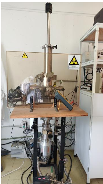
Figura 19. Espectrómetro de fluorescencia de rayos X, del laboratorio de aerosoles en el Instituto de Física de la UNAM.
