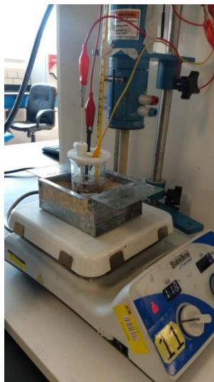
Figura 5. Celda electroquímica para las técnicas de voltamperometría (VC).
