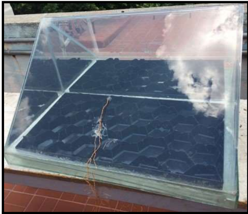
Ilustración 14. Destilador solar tipo caseta con reflectores internos.
