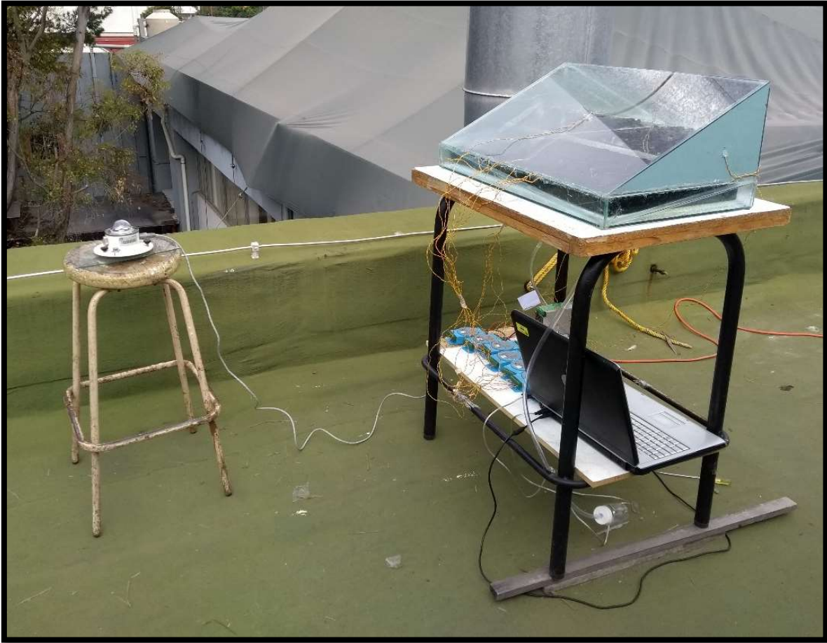
Ilustración 17. Destilador solar y equipo utilizado durante la prueba piloto.
