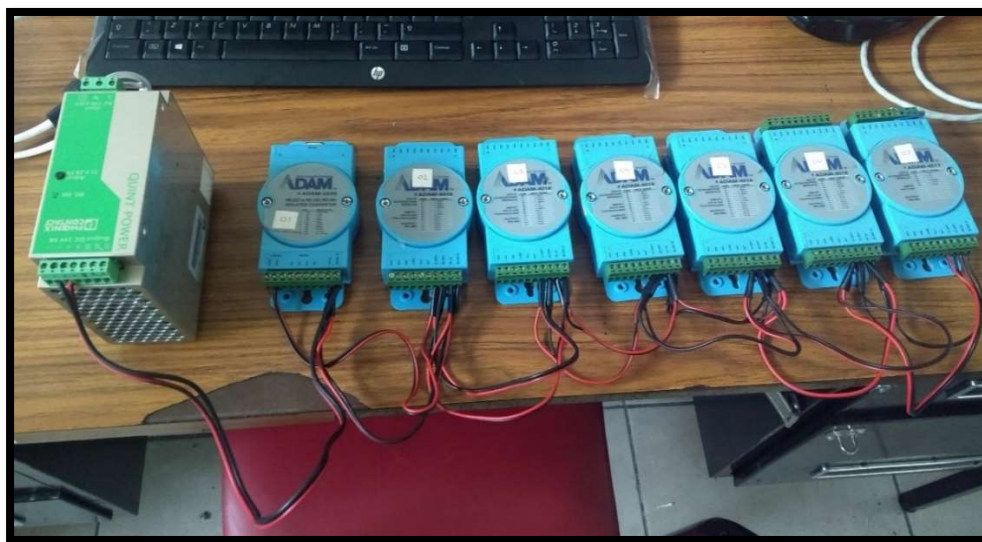
Ilustración 12. Conexión de todos los módulos ADAM 4000.
