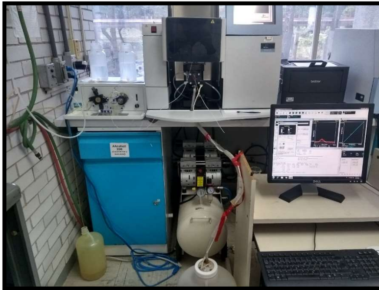
Ilustración 25. Espectrofotómetro Perkin Elmer AAnalyst 100 con sistema de inyección en flujo continuo (FIAS).
