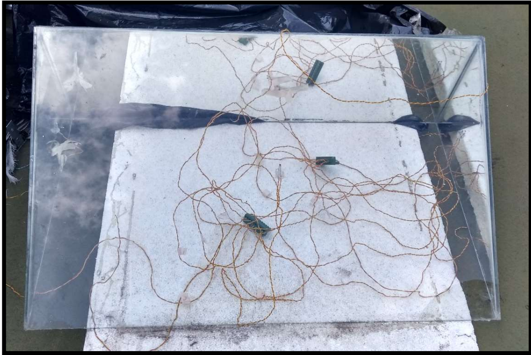
Ilustración 15. Termopares colocados en la cubierta.
