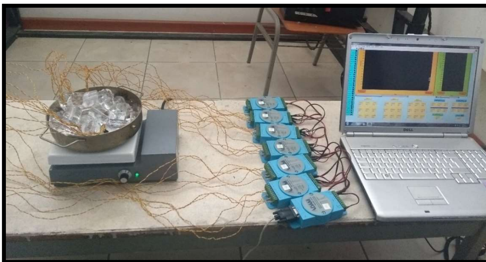
Ilustración 13. Calibración de termopares ocupando módulos ADAM.
