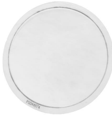
Figura 3. 10 Filtro de teflón con muestra recolectada de \text{PM}_{2.5} .
