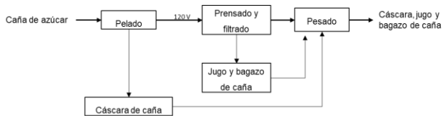
Figura 1. Diagrama de bloques del proceso para la determinación de los componentes de la caña de azúcar. Fuente: Elaboración propia con base al proceso tradicional de prensado, 2021.
