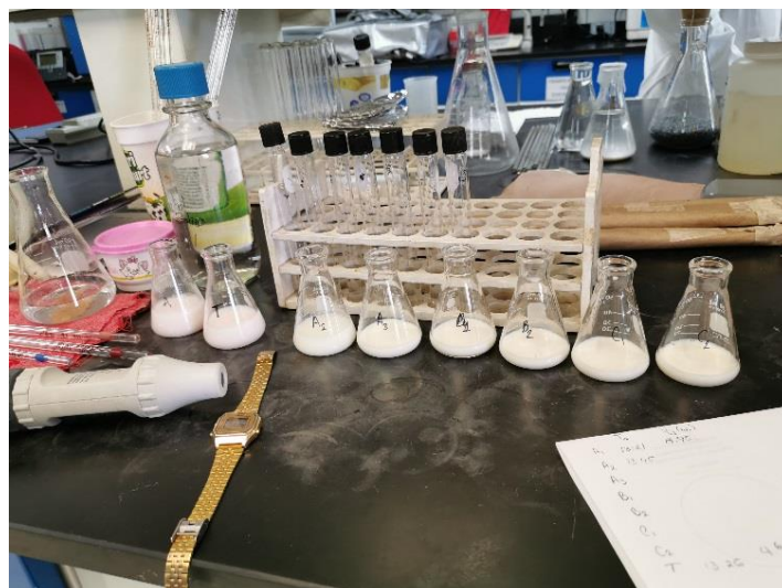
Figura 4.10 Medición de actividad enzimática mediante titulación.
