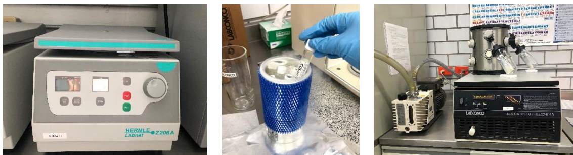
Figura 12. A la izquierda centrifuga HERMLE Labnet Z206A, al centro viales sumergidos en nitrógeno líquido y a la derecha el sistema de liofilización LABCONCO.
