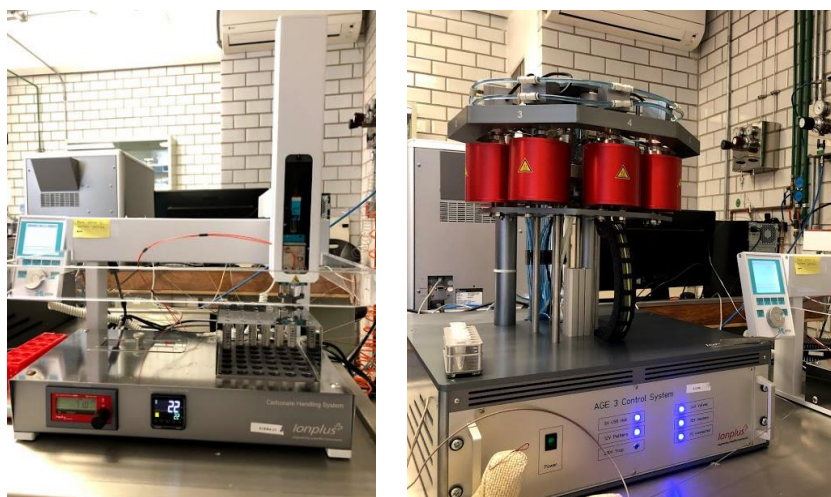
Figura 15. A la izquierda el sistema de manejo de carbonatos lon Plus y a la derecha el equipo automatizado de grafitización (AGE III).
