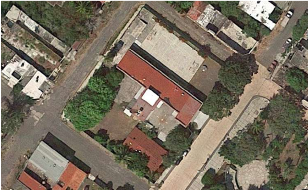
Figura 4. Foto satelital de la Escuela Primaria Rafaela Suárez. En la parte superior de la foto (norte) la parte del edificio original de Leduc, Construida en los años 40, en la parte sur, aulas contemporaneas edificadas en los años 80 con el modelo unitario CAPFCE.
