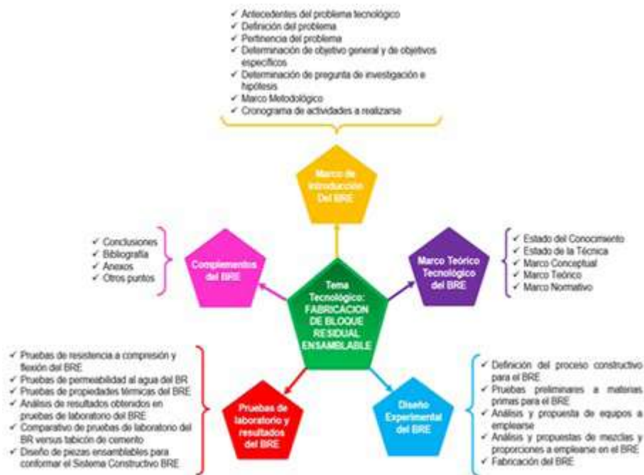
Figura 8. Diseño de Metodología para la fabricación del Block Residual Ensamblable (BRE).
