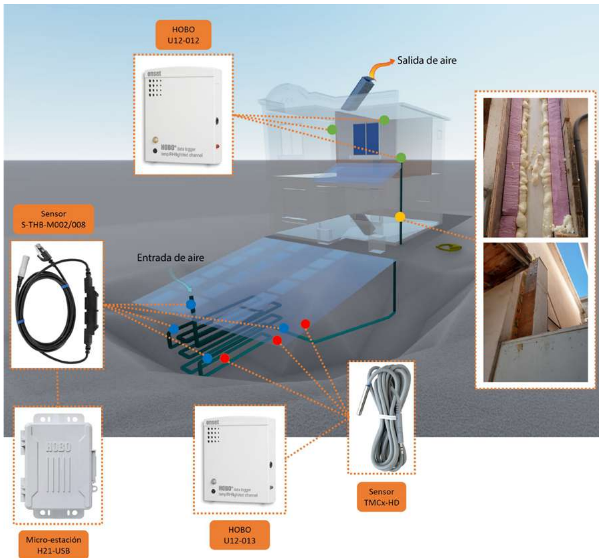
Figura 1. Esquema general del ICTA y ubicación de instrumentos de medición.
