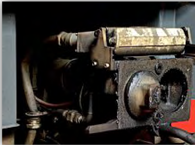
Ilustración 34.- Enganche automático tipo Scharfenberg de un automotor eléctrico de la serie 3500 de CP, foto tomada de: Eisenbahn_Schraubekupplun
