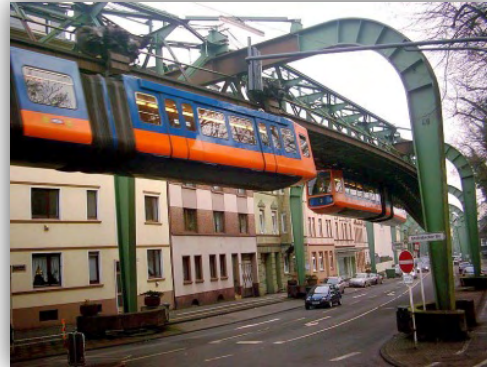
Ilustración 6.- Tren suspendido, su elevación de las calles es de 18.2 m, ilustración obtenida de: http://www.schwebebahn.de/en/history-technology/history
