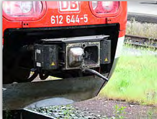
Ilustración 33.- Acople automático Scharfenberg, foto tomada de: Eisenbahn_Schraubekupplun
