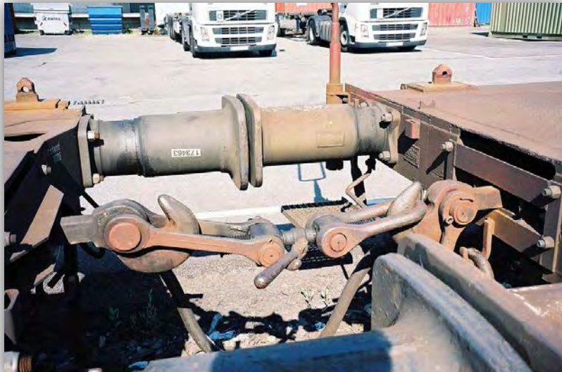
Ilustración 32.- Acople Manual de tope y cadena, fotografiada tomada de: Eisenbahn_Schraubkuppelung
