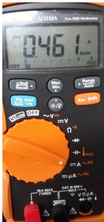
Figura 29.- Corriente de salida del convertidor reductor.
