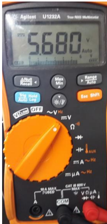
Figura 28.- Voltaje de salida del convertidor reductor.
