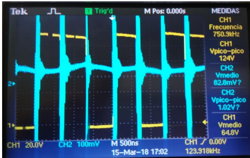
Figura 26.- Corriente del convertidor reductor en color azul.
