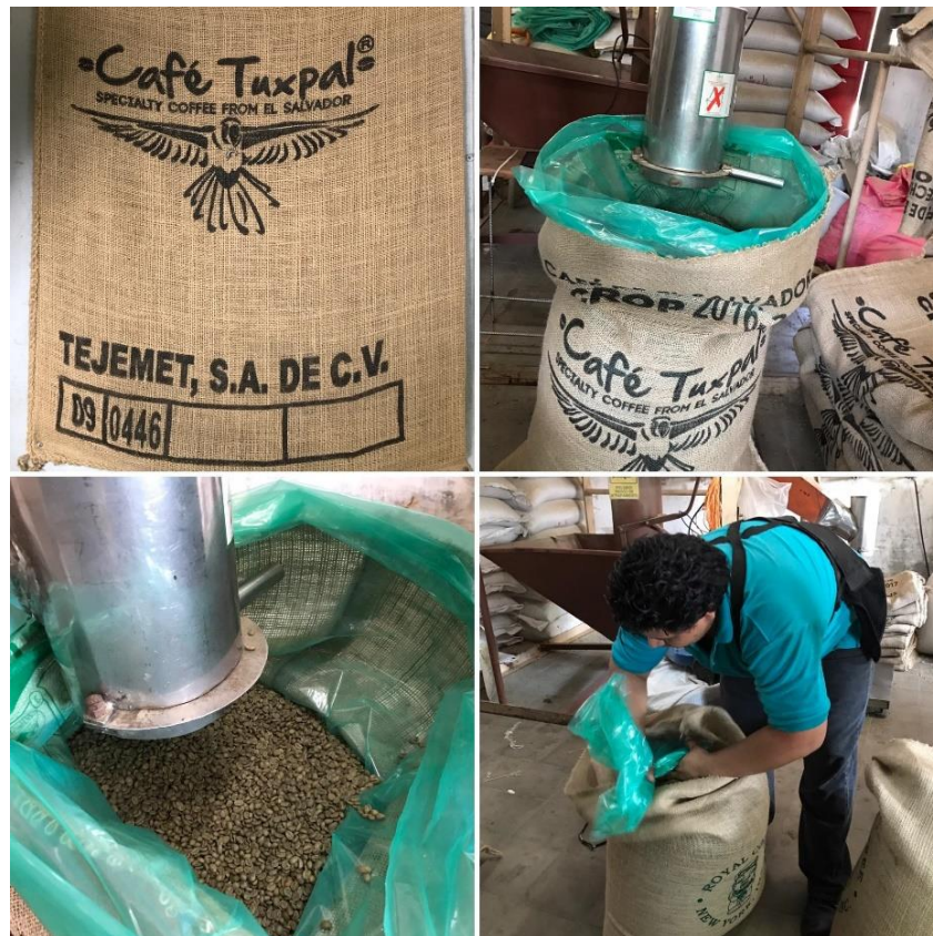
Figura 2. Envasado de 69 kg de granos verdes en bolsas de polietileno y sacos de henequén.
