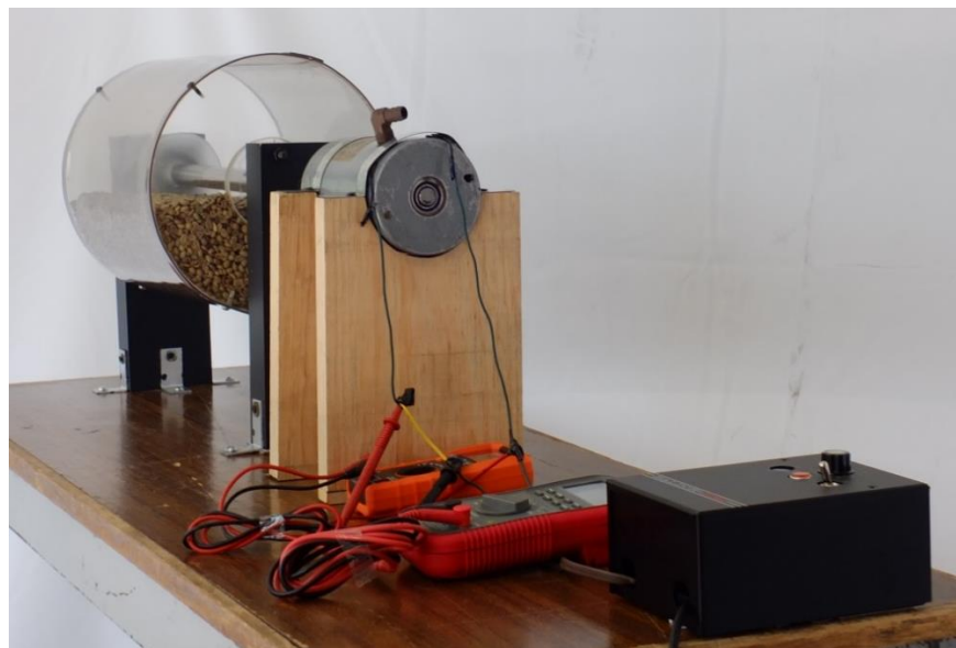
Figura 8. Modelo de la cámara de tostado, con la instrumentación para caracterizar el mezclado.
