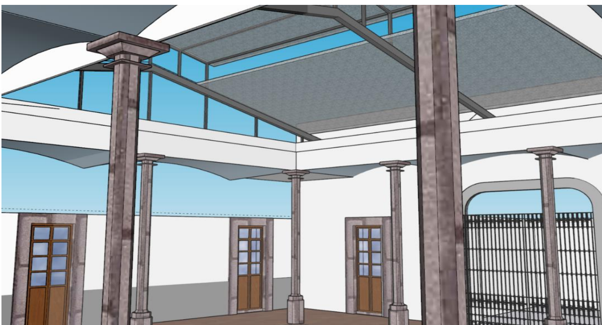
Figura 48. Iluminación y ventilación natural del patio central. Fuente: Elaboración Karina M.A.
