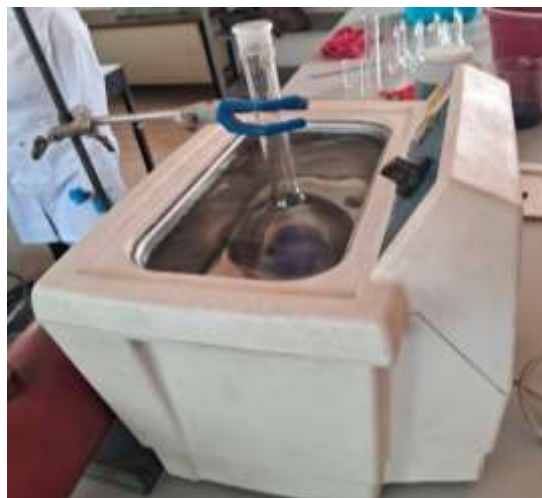
Figura 3. Fotografía del sistema de reacción para la decoloración de soluciones de RB5 mediante ultrasonido.
