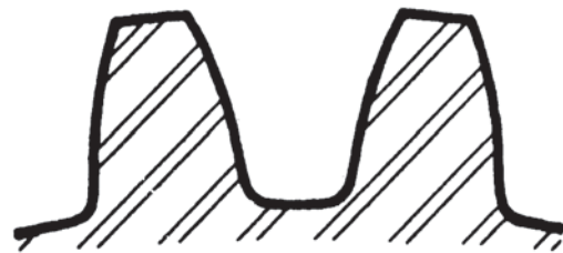
Paso Diametral 2\frac{1}{2} Paso Circular de 1.2566"
