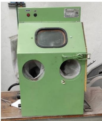
Ilustración 6: Cabina de Sand Blast modelo LJD-S
