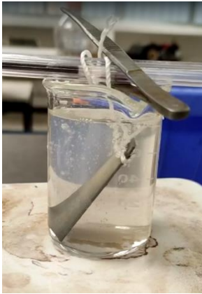
Ilustración 9: Sustrato sumergido en el baño de fosfato de manganeso
