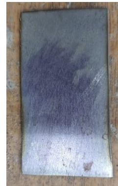
Ilustración 8: Sustrato sin rebabas
