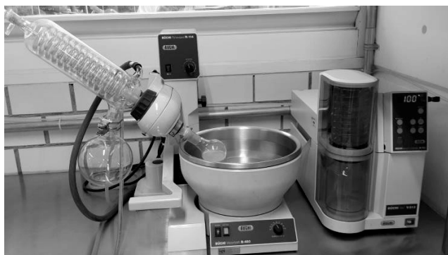
Figura 10. Obtención de concentrado mediante evaporación en rotovapor BUCHI R-114
