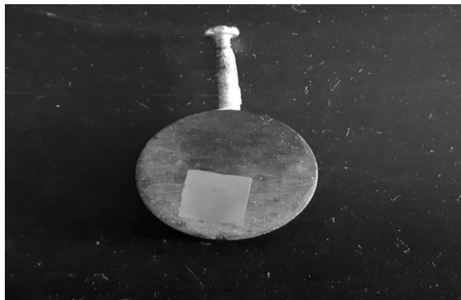
Figura 9. Probeta de Acero API 5L X52 montada en baquelita con contacto metálico.
