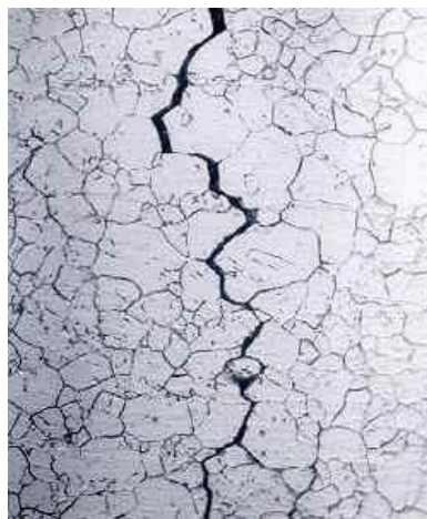
Figura 7. Metalografía de corrosión por esfuerzo intergranular en un intercambiador de calor de Inconel.
