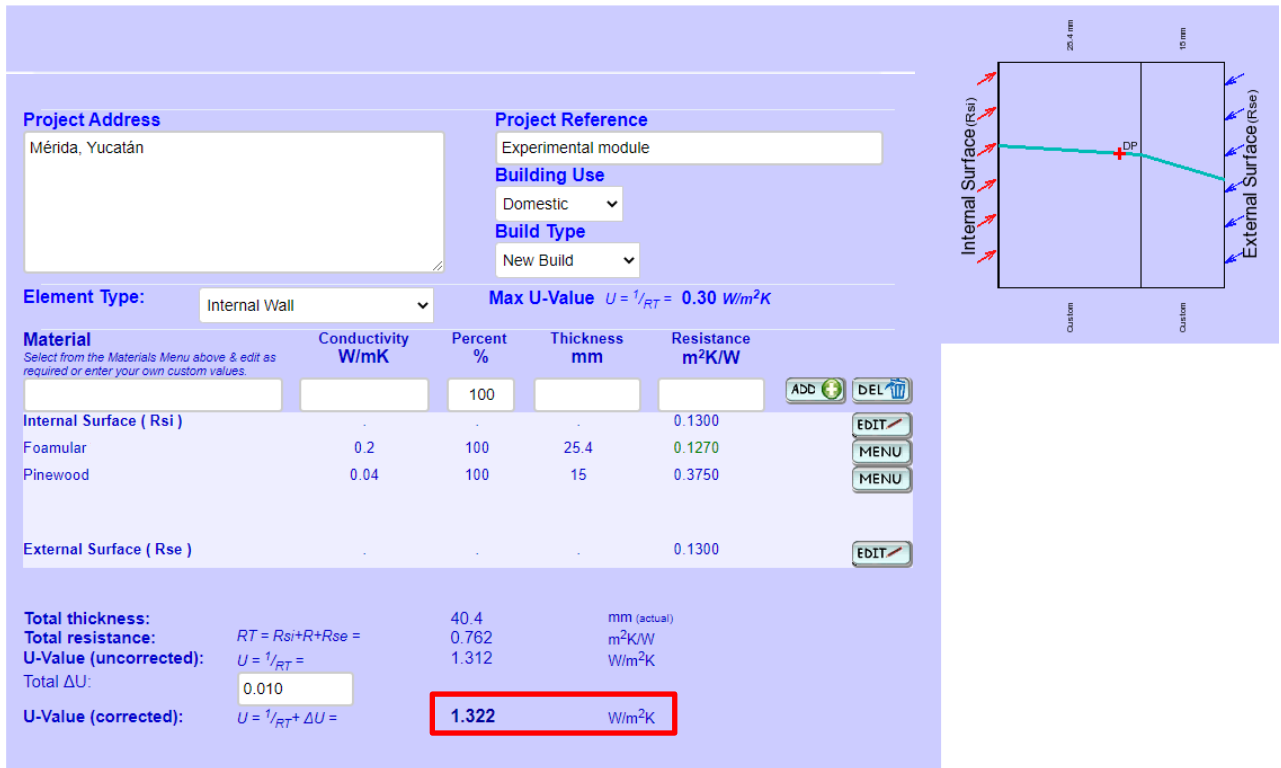
Fig. 4-24 Cálculo de U para el caso de estudio. Fuente: https://www.changeplan.co.uk/u_value_calculator.php (2020).
