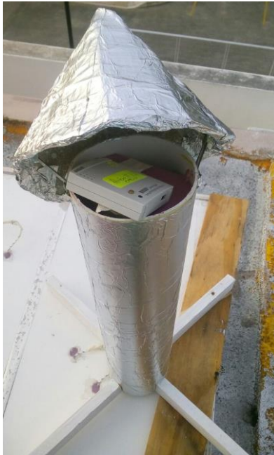
Fig. 5-4 Colocación de Hobo U-12 dentro de la pantalla de Stevenson. Fuente: Elaboración propia.
