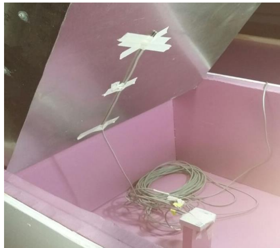
Fig. 5-3 Colocación de Hobo U-12 con sensores de superficie y agua dentro del Módulo 4. Fuente: Elaboración propia.
