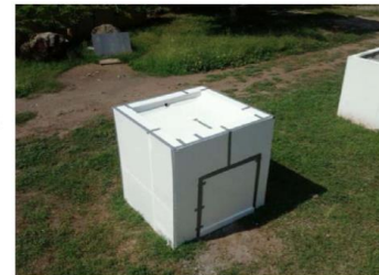
Fig. 12. Módulo experimental forrado con 0.04 m de poliestireno. Fuente: Autor.
