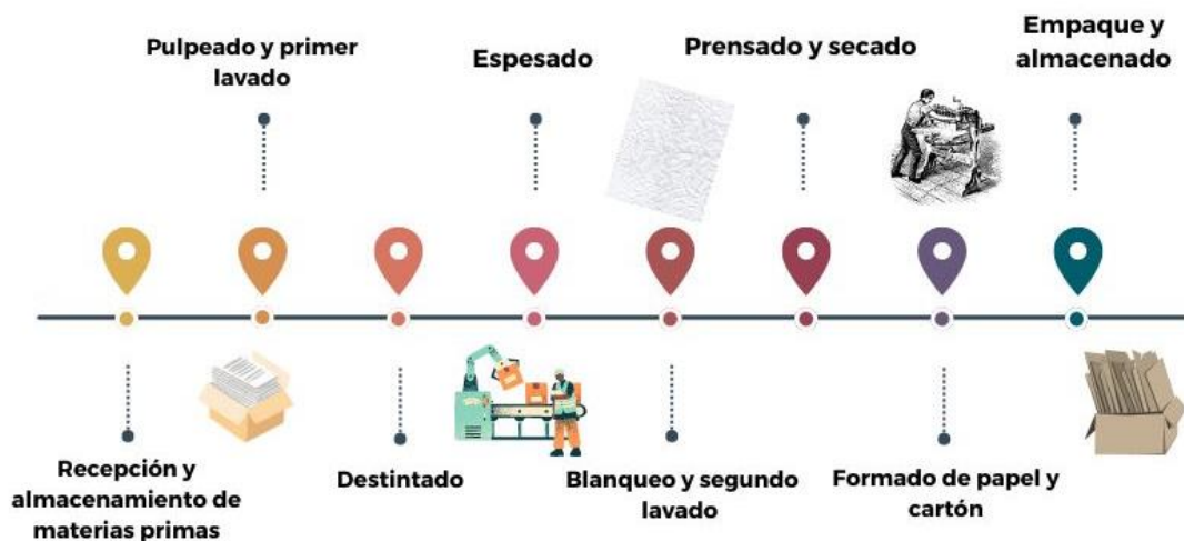
Figura 5. Proceso de fabricación del papel y cartón reciclado (Eco.business, 2021)
