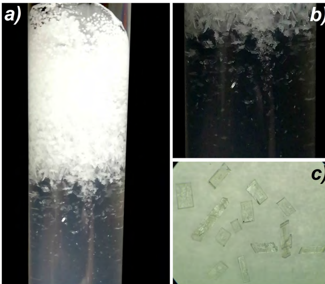
Figura 3.3.1: (a, b) Sistema de crecimiento de cristales. (c) Monocristales facetados completamente definidos con tamaños que van desde 15 \mu\text{m}^3 hasta 6 \text{ mm}^3 fueron obtenidos en un periodo dos semanas.
