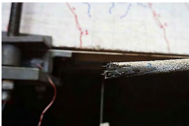
Figura 6-73 Falla de barra PRFC sobre el desviador derecho a detalle
