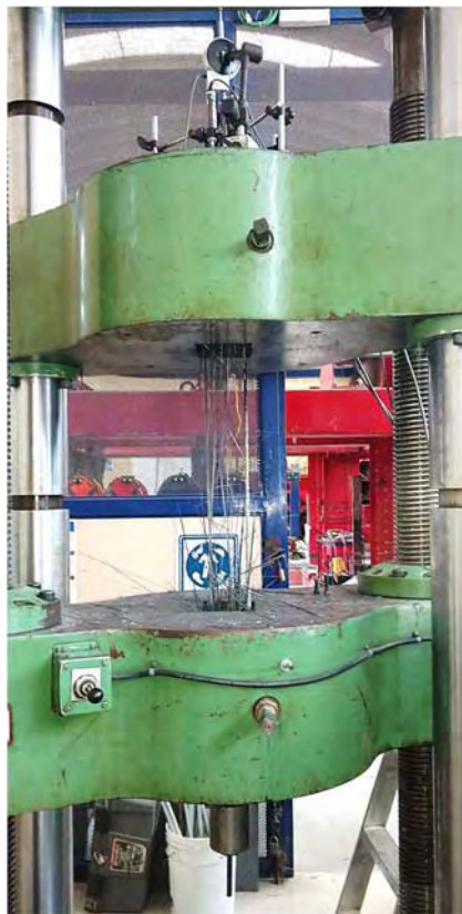
Figura 5-18 Falla tipo escoba de espécimen en longitud libre
