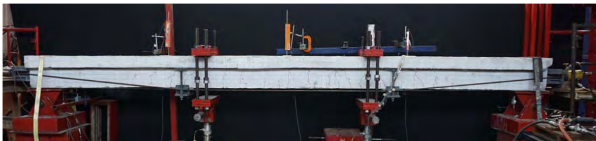
Figura 6-84 Desviación con el refuerzo de torones de acero de la Viga 3
