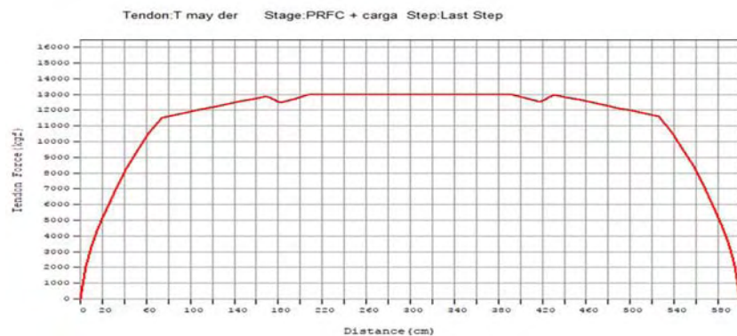
Figura 9-12 Presfuerzo en torón interno después de aplicación de presfuerzo externo y con 4000 kg de carga
