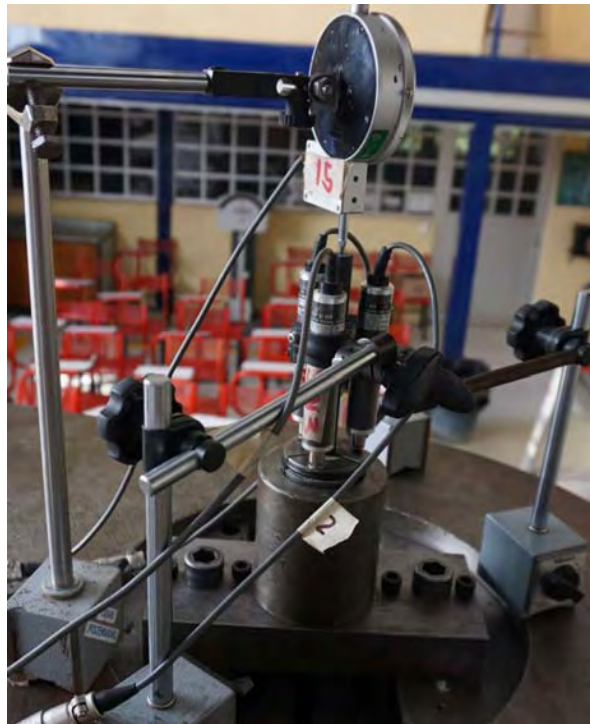
Figura 5-16 Instrumentación de anclaje físico
