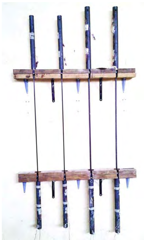
Figura 3-9 Ensamble de anclajes con barras e instrumentación
