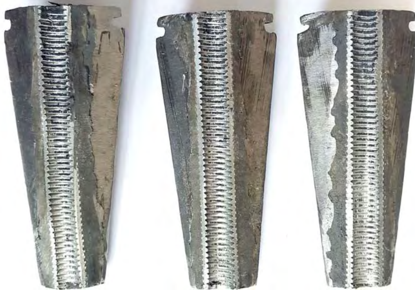
Figura 5-22 Anclaje Juego 4 (inferior) sin daño visible
