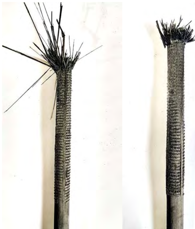
Figura 5-23 Barra con marcas de dientes de cuñas, sin daño en zona de anclaje
