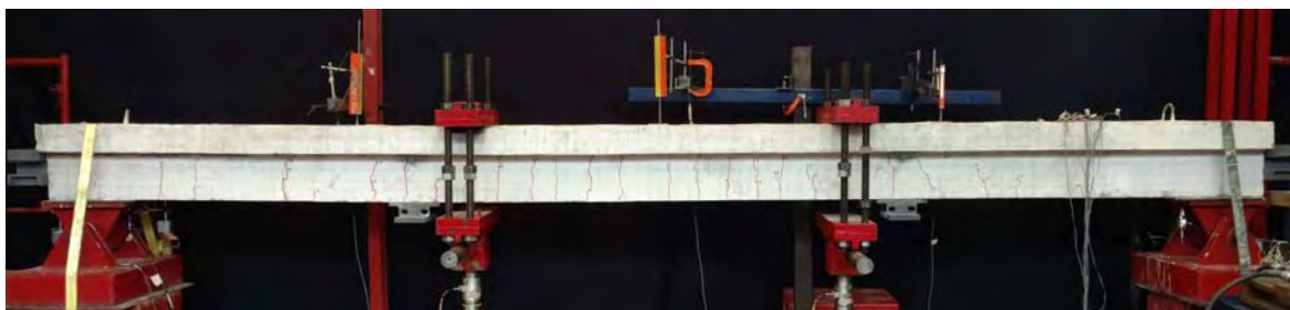
Figura 6-55 Pre-agrietamiento a 0.3 mm de espesor – vista frontal
