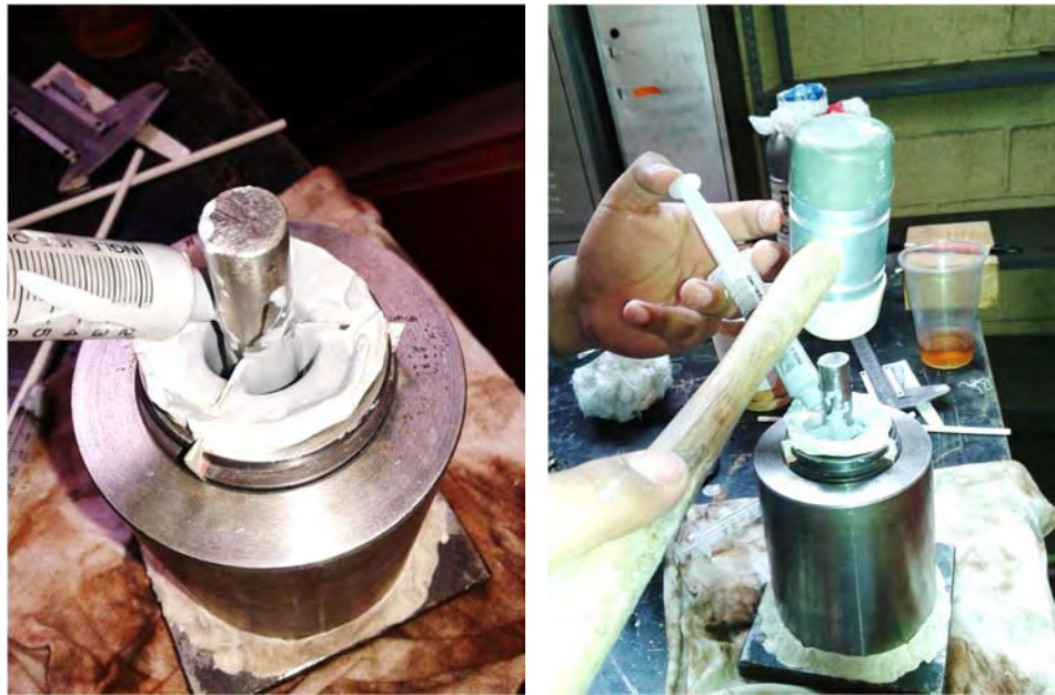
Figura 5-11 Inyección de epoxi líquido en molde
