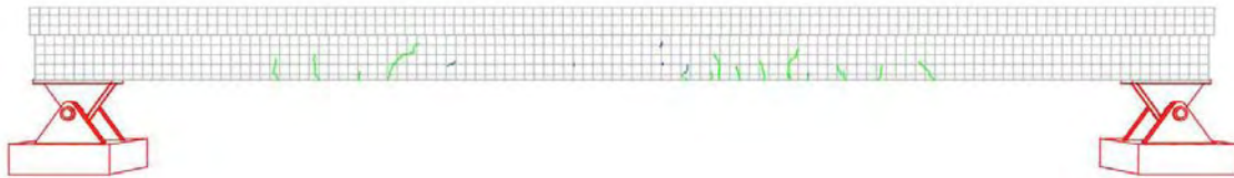
Figura 10-17 Pre-agrietamiento - Grosor máx. 0.2 mm a 1,000 kg
