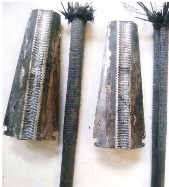
Figura 5-20 Superficies de cuñas y de barras sin señal de daño
