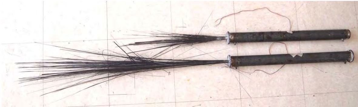
Figura 3-13 Falla típica de barras PRF tipo “escoba” observada con tubos
