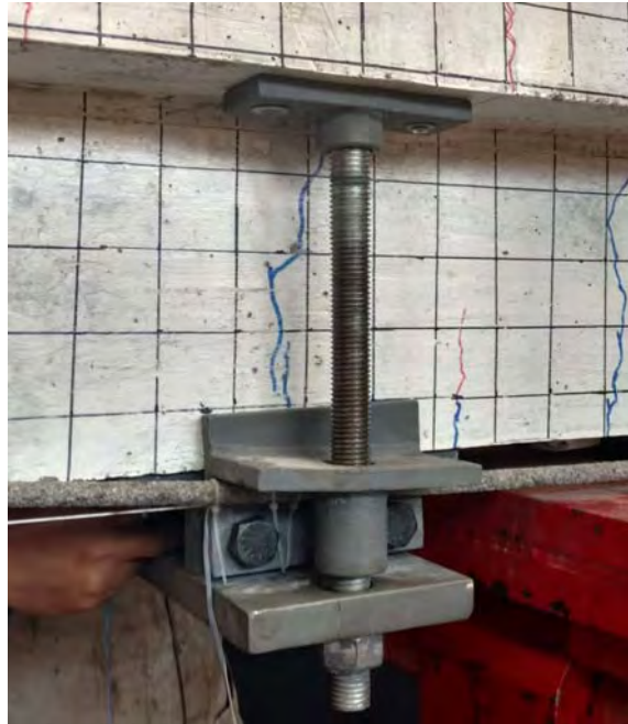
Figura 6-26 Desviador instalado sobre una viga en posición de desviación máxima
