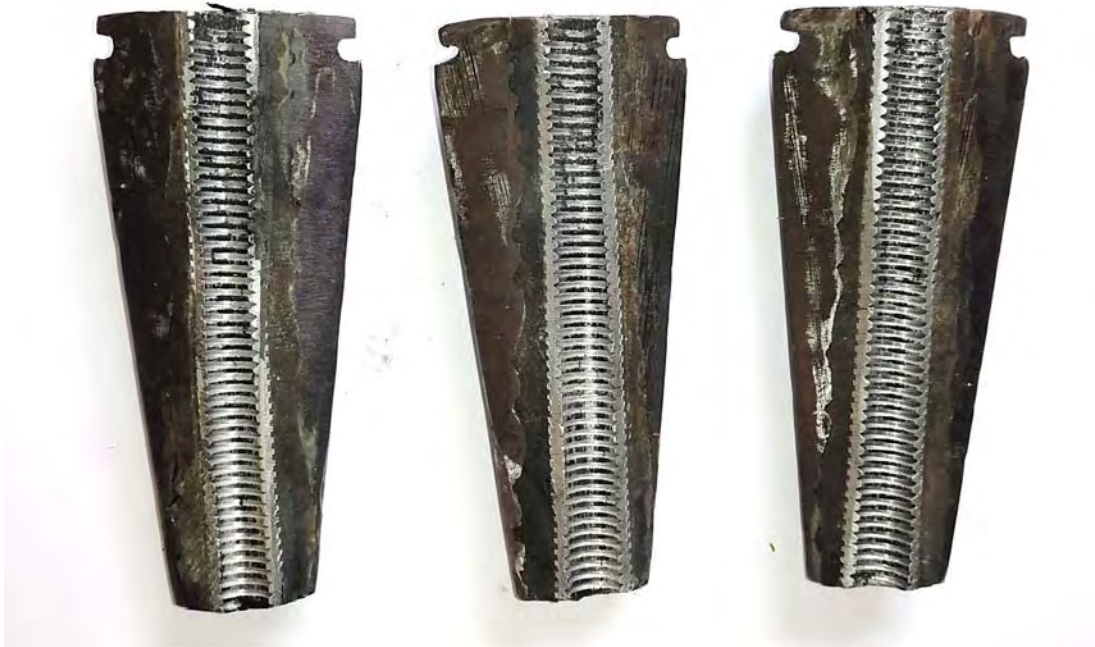
Figura 5-21 Anclaje Juego 5 (superior) sin daño visible
