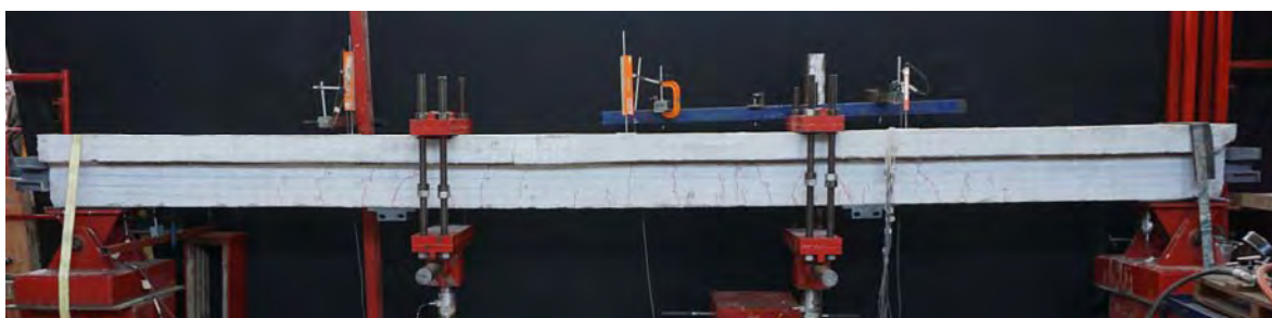
Figura 6-79 Pre-agrietamiento a 0.3 mm de espesor – vista frontal
