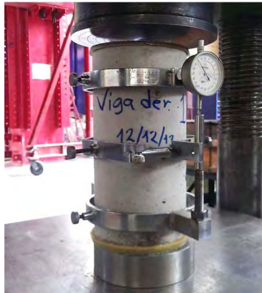
Figura 6-17 Determinación de propiedades de concreto de vigas en laboratorio
