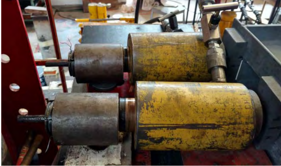
Figura 6-23 Viga de reacción con anclajes y gatos hidráulicos
