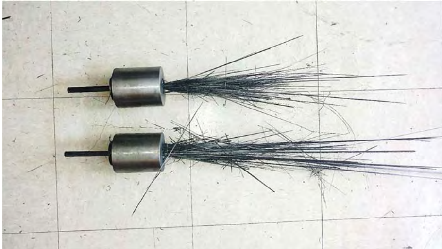
Figura 5-19 Falla tipo escoba de espécimen en longitud libre
