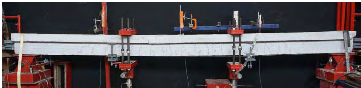
Figura 6-92 Deformación visible de la Viga 3 alcanzando su falla última
