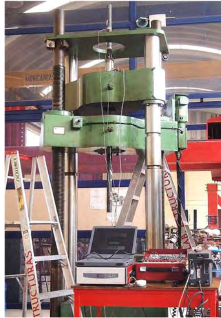
Figura 3-7 Arreglo de ensayo en máquina universal
