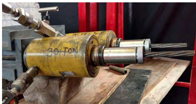
Figura 6-86 Anclajes para torones de acero de 1/2" tipo SureLock
