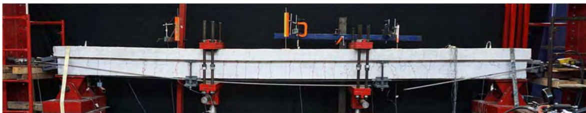
Figura 6-72 Falla de barra PRFC sobre el desviador derecho
