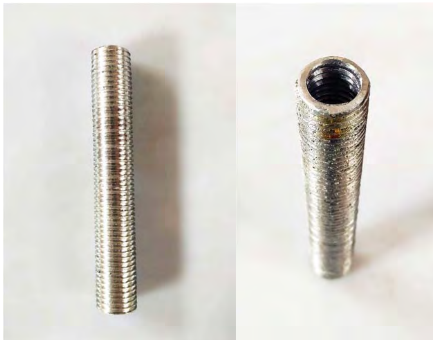
Figura 5-12 Tubo de aluminio final con corrugaciones
