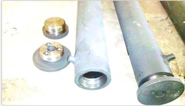
Figura 3-6 Extremos de tubos con roscas y entrada para inyección
