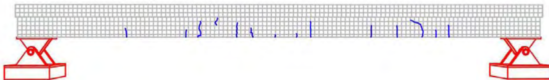
Figura 10-13 Pre-agrietamiento - Grosor máx. 0.2 mm a 1,000 kg
