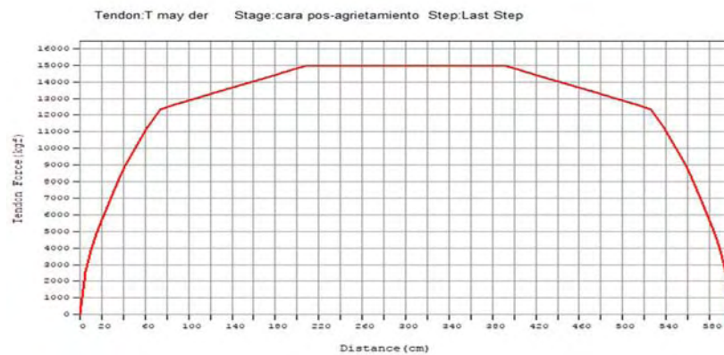
Figura 9-10 Tensión en 1 torón aplicando 4000 kg de carga con sección agrietada
