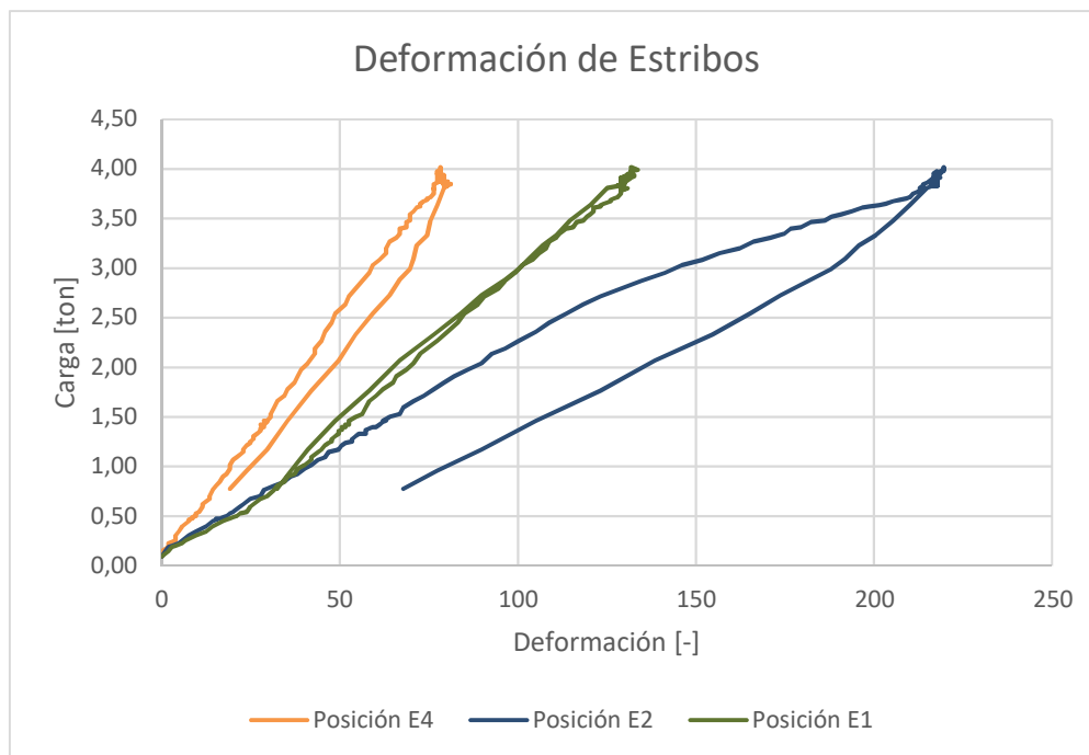
Figura 11-12 Ensayo a falla final de Viga 2 – Deformación de estribos
