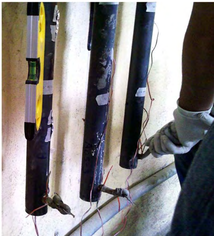
Figura 3-11 Control de geometría e instrumentación de barras
