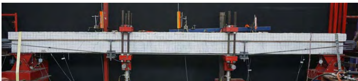
Figura 6-42 Viga 1 con presfuerzo externo aplicado y desviado
