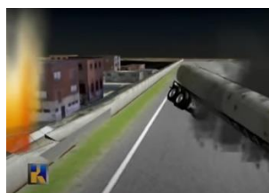
Figura 5a. Desplazamiento del primer contenedor a través de la vialidad debido a la onda de sobrepresión.
