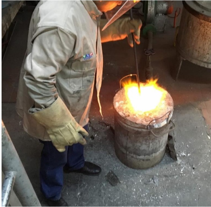
Figura 19. Generación de caldo (cobre), con apoyo de varilla.
