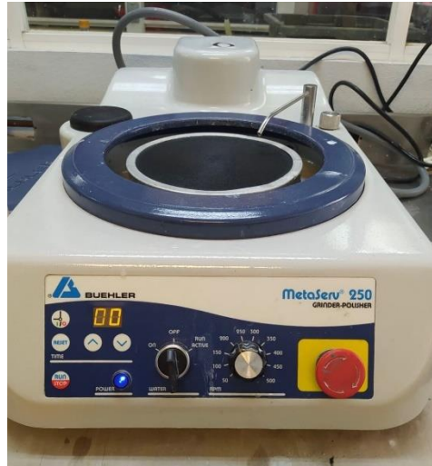
Figura 36. Pulidora metalográfica marca: Buehler mod: metaserv 250
