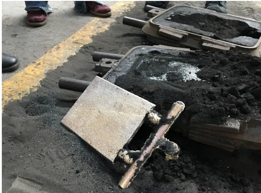
Figura 24. Desmoldeo de placa Cu-Al-Ag.
