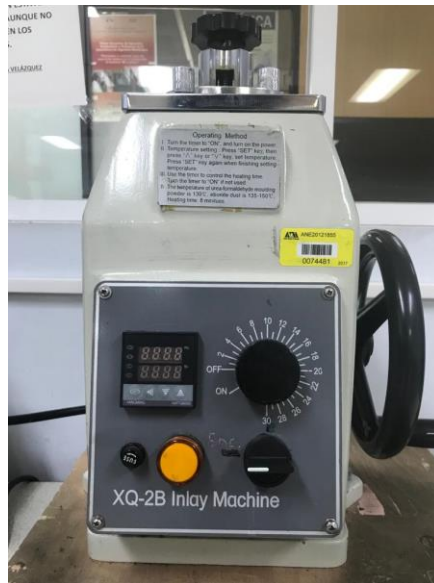
Figura 34. Montadora Inlay Machine Mod: XQ-2B
