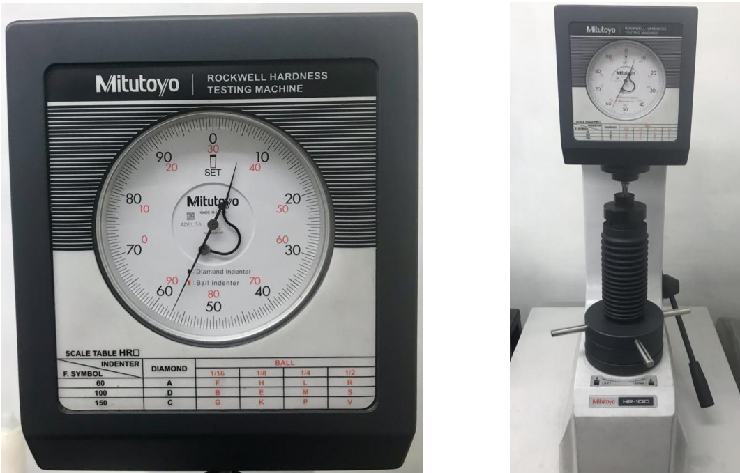
Figura 39. Reloj durómetro e indentación de probeta marca: Mitutoyo mod: HR-100
