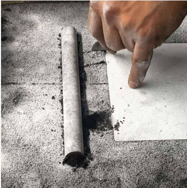
Figura 13. Creación de salida de gases y canales de alimentación.
