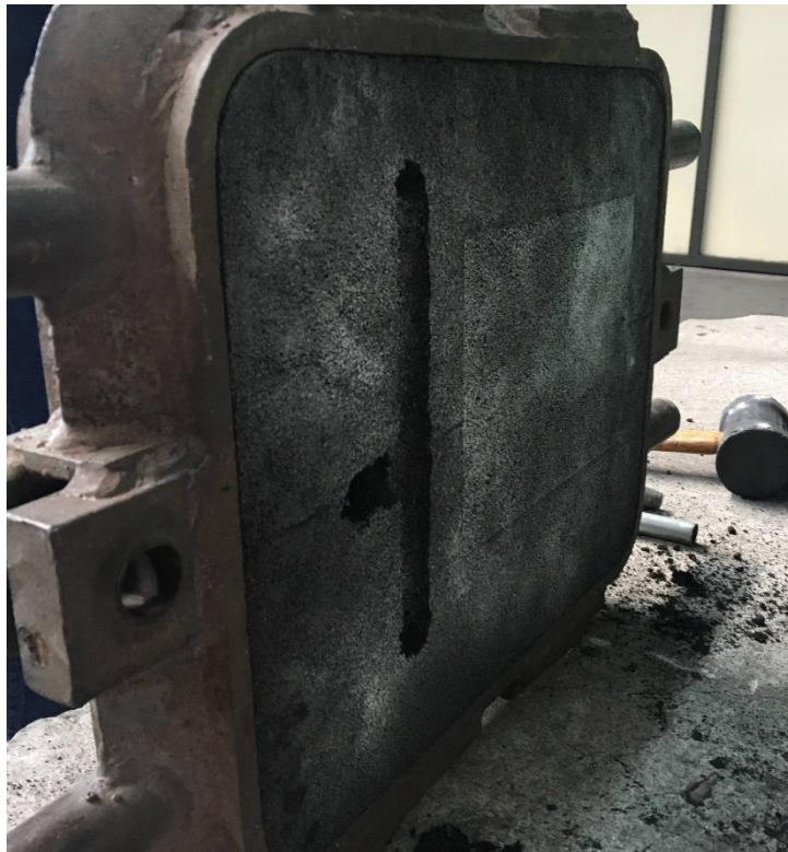
Figura 16. Sopleteo del molde antes del vaciado
