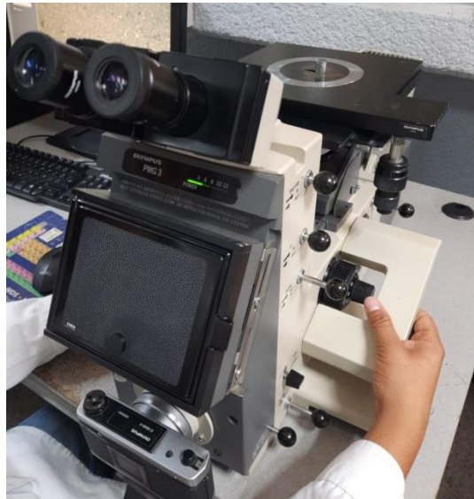
Figura 38. Microscopio metalográfico marca: Optimus mod: PMG 3
