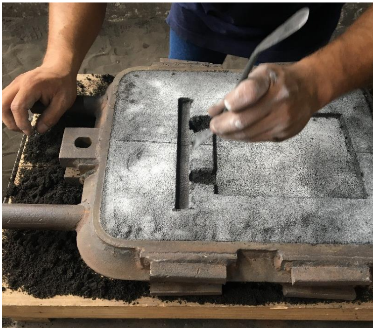
Figura 13. Creación de salida de gases y canales de alimentación.
