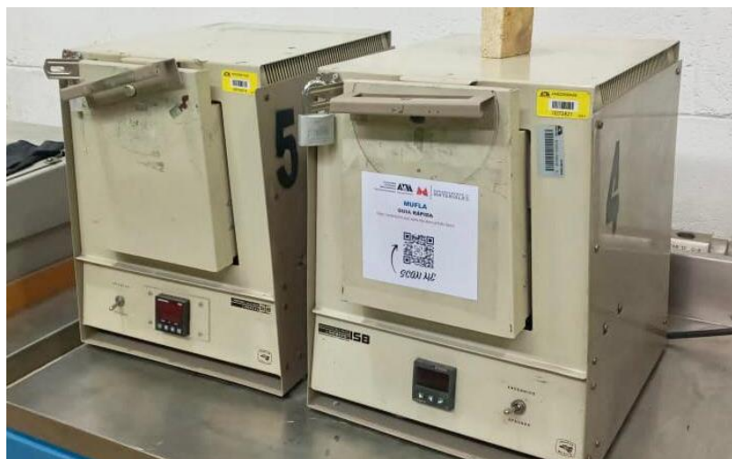
Figura 33. Horno tipo mufla utilizado para tratamientos térmicos
