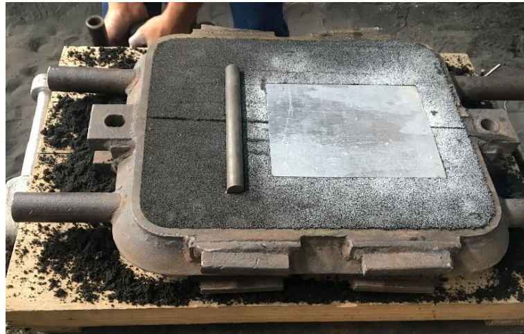
Figura 12. Extracción del modelo, creación de salida de gases.
