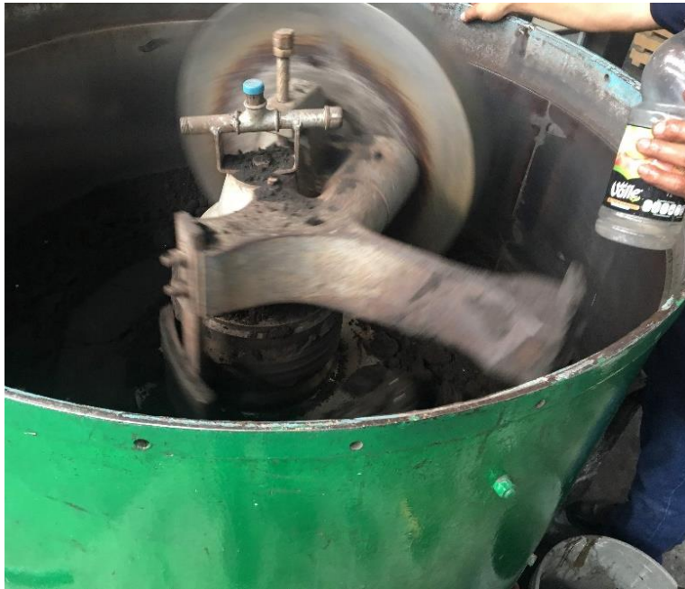
Figura 5. Preparación de arena en verde en maquina convencional con rodillos marca ANTAI / ATHI, Mod. S11.
