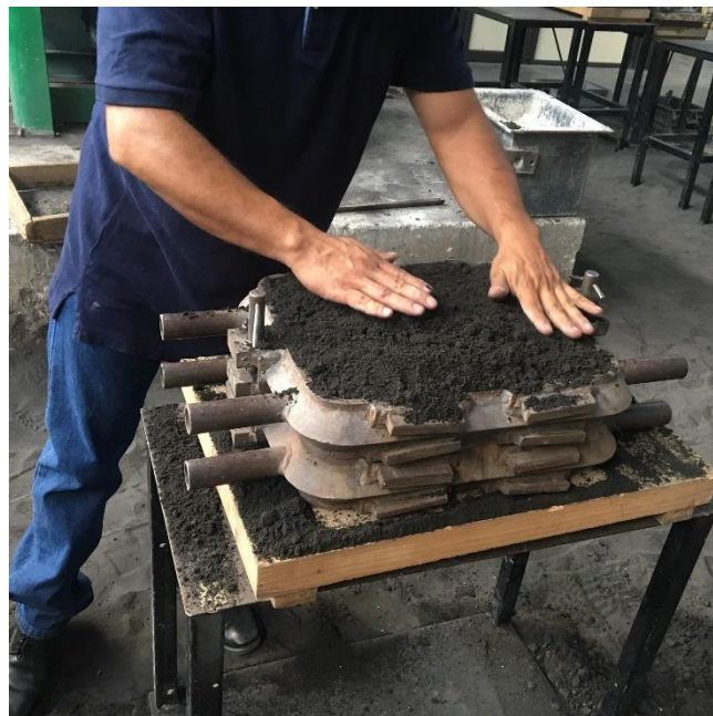
Figura 8. Llenado de adobera con arena de relleno antes del apisonado.
