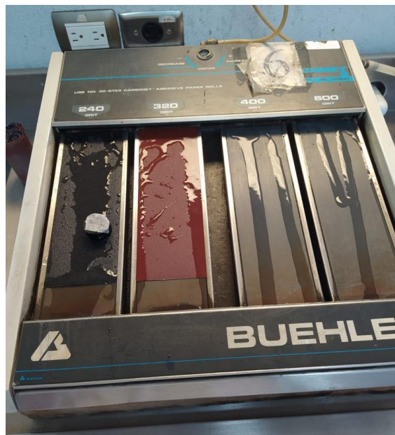
Figura 35. Banco de lijado marca: Buehler mod: S1
