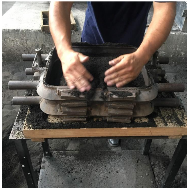
Figura 6. Preparación de la caja de moldeo parte inferior.
