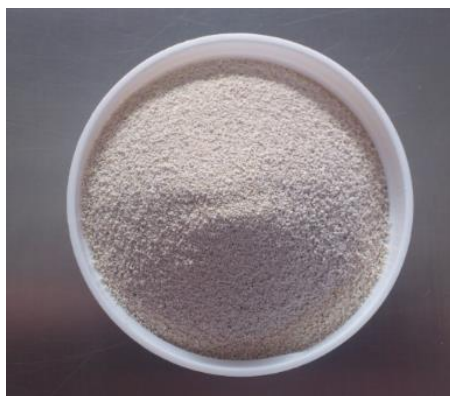
Figura 4.4 Clinoptilolita después de la molienda y el tamizado
