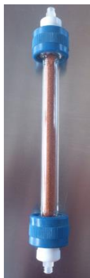
Figura 4.8 Columna empacada con clinoptilolita dopada con hierro
