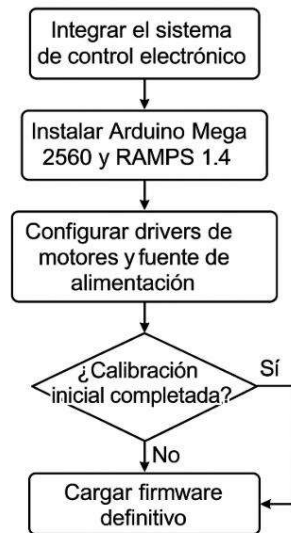
6.3 Diagrama de sistema de control
