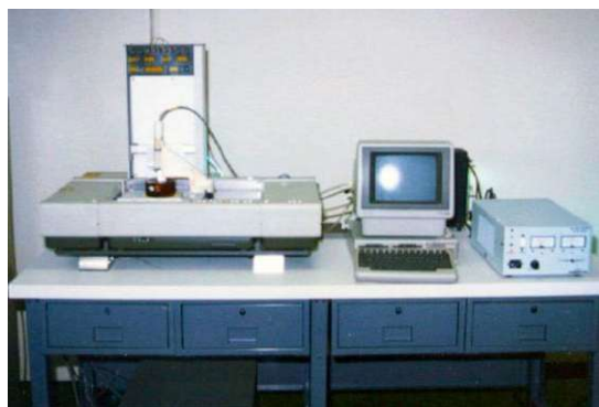
12.1 Prototipo de la impresora SLA-1 Fuente: HipertextualContenido
