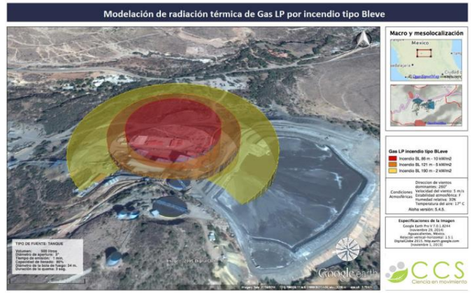
Figura III.2.15 Gas L.P. por incendio tipo BLEVE
