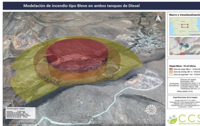
Figura III.2.22 Diésel por incendio tipo BLEVE en tanques de 60 m 3 y 15 m 3
