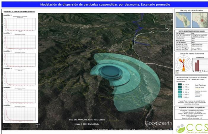
Figura III.1.3 Desmonte de terreno natural. Escenario promedio
