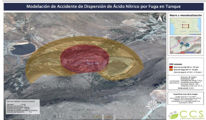
Figura III.2.13 ácido nítrico por fuga en tanque de almacenamiento
