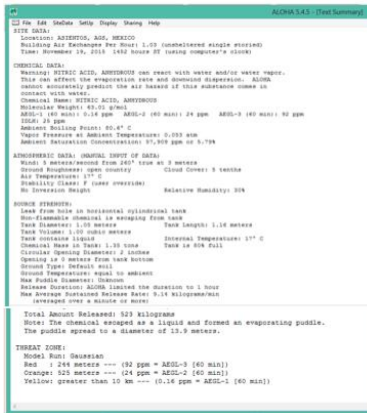
Figura III.2.2 Corrida en ALOHA 5.4.5 para ácido nítrico por fuga en tanque de almacenamiento.
