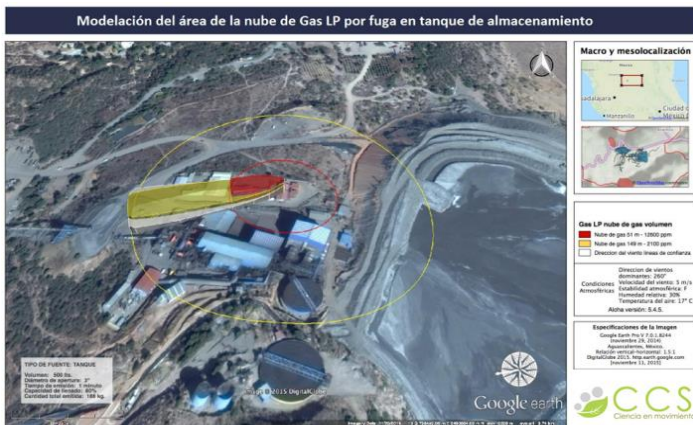
Figura III.2.18 Gas L.P. por fuga en tanque de almacenamiento
