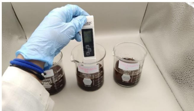
Figura 6-15. Determinación de la conductividad eléctrica
