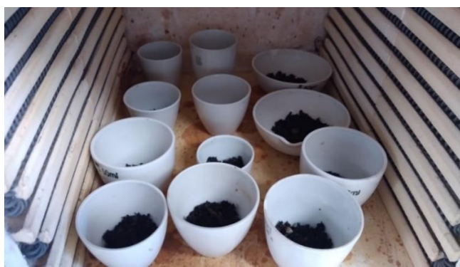
Figura 6-9. Muestras sometidas a calcinación en mufla a 650 °C
