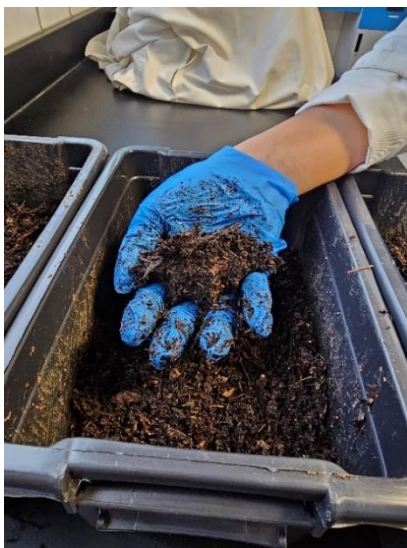
Figura 6-16. De demostración de la "prueba de puño" para determinación de humedad
