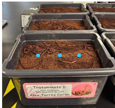
Figura 6-13. Puntos específicos para registrar la temperatura
