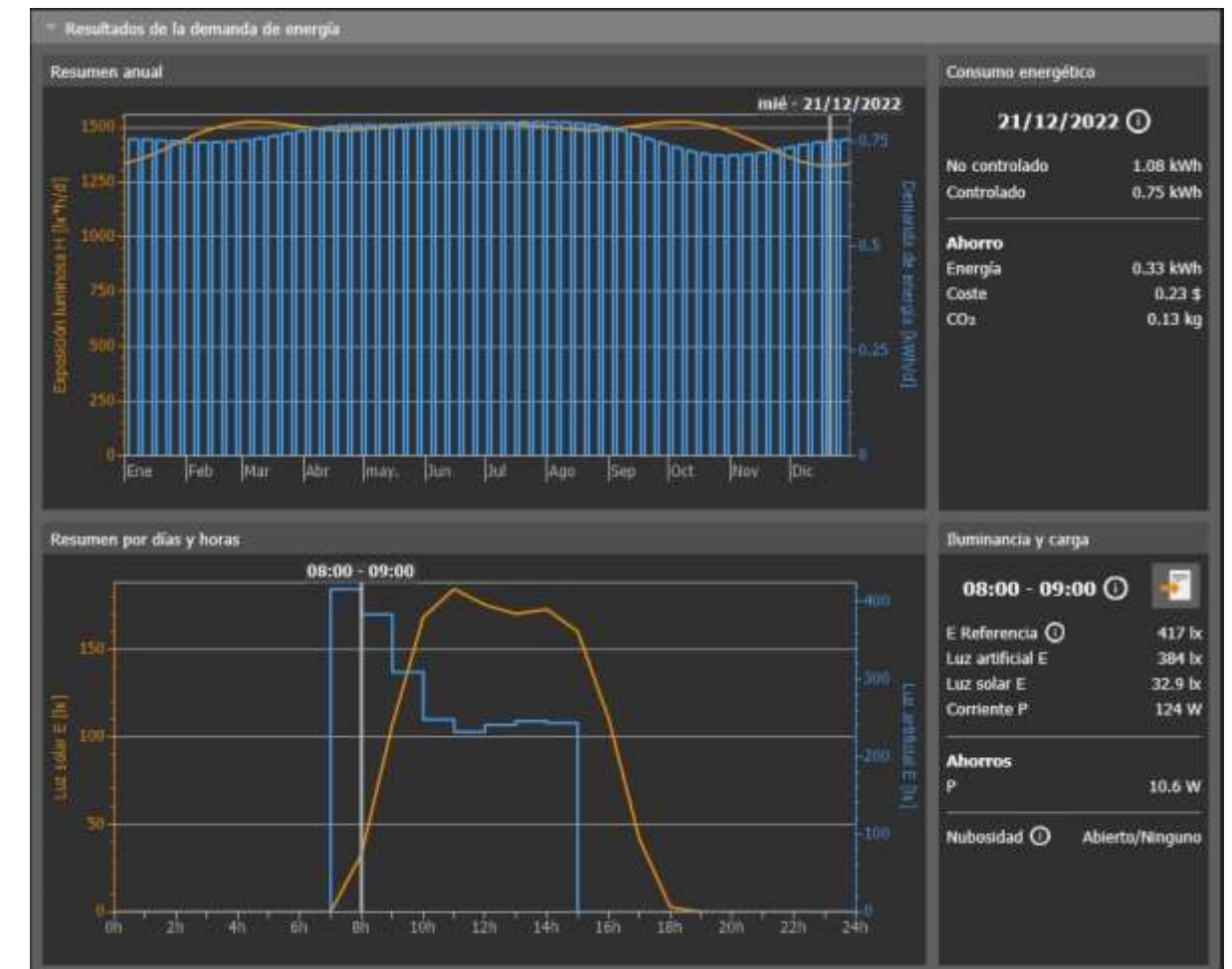
Figura 135. Aula tipo N1. Demanda de energía. Fuente: Elaboración propia mediante DIALux evo. (DIAL GmbH, 2024)
