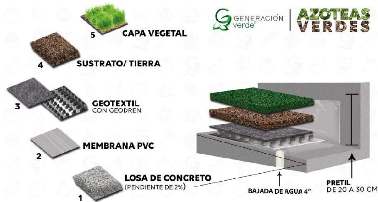
Figura 202. Esquema de componentes de un sistema de azotea verde. Fuente: https://generacionverde.com/azoteas-verdes/
