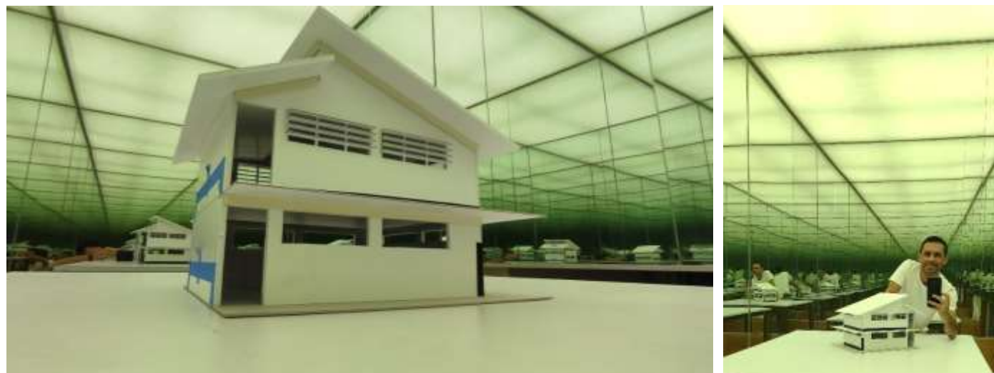
Figura 121. Evaluación de modelo físico en cielo artificial UAM Azcapotzalco. Fuente: Elaboración propia
