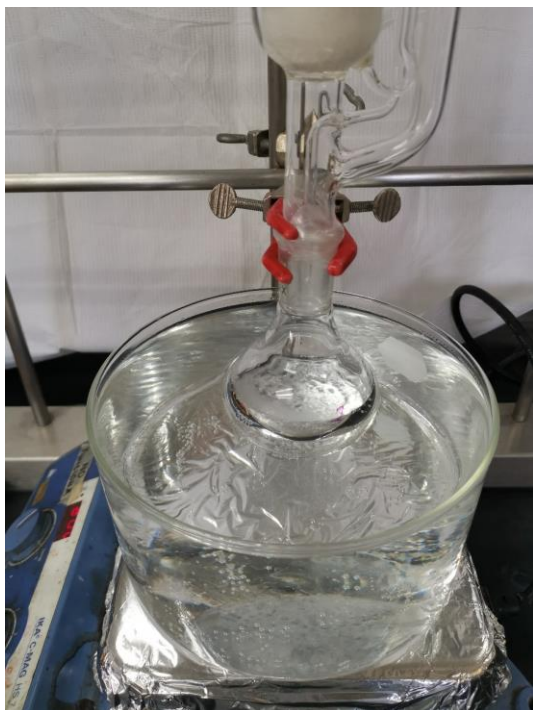
Fotografía 6. Sistema Soxhlet con solvente n-hexano.
