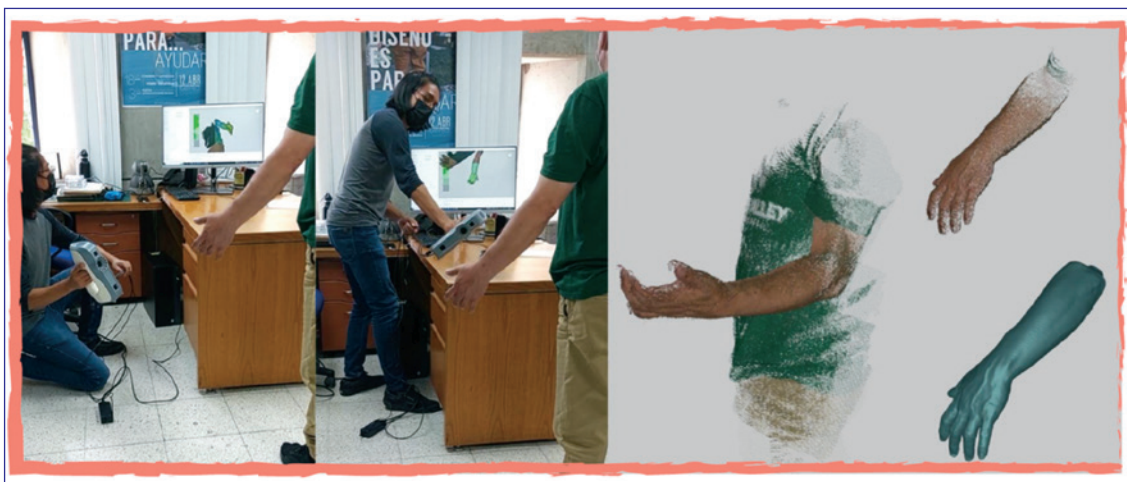
Figura 5. El uso de un escáner 3D permite digitalizar las medidas específicas de un brazo para desarrollar proyectos de diseño único, como prótesis o ayudas técnicas. Crédito: Saúl Hernández.
