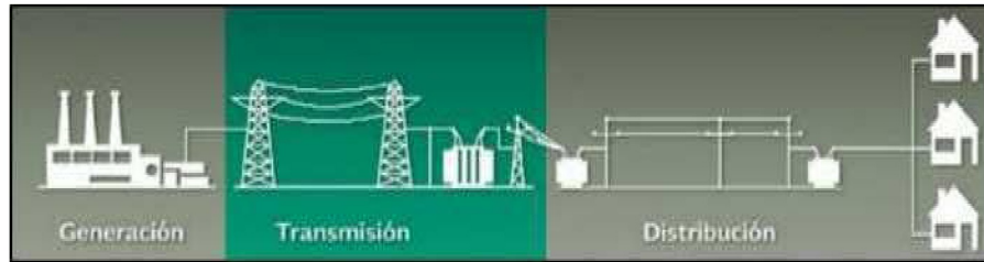
Figura 2.2 Sistema Eléctrico Interconectado (Generación, Transmisión, Distribución). Fuente: CFE
