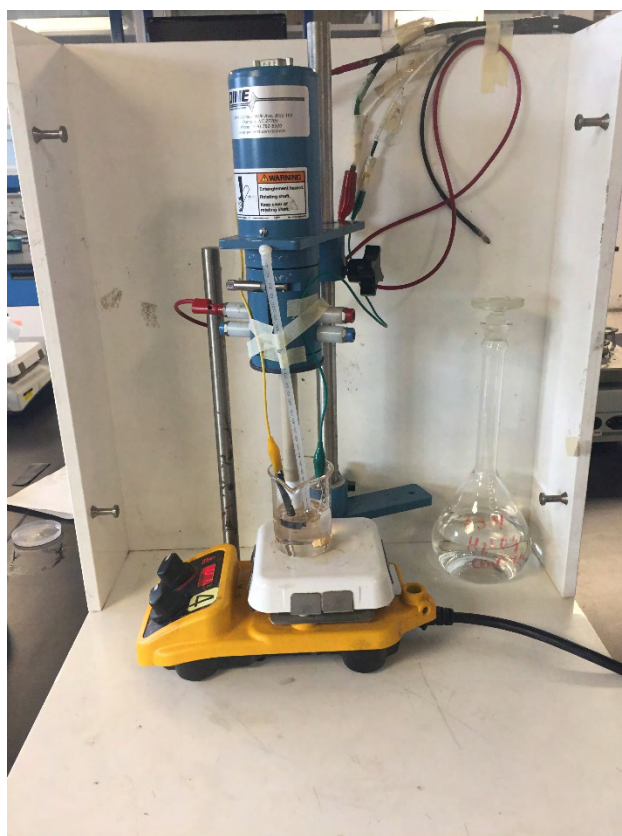
Figura 1. Celda electroquímica conectada al equipo PAR versa STAT 4 para realizar voltamperometría cíclica y cronoamperometría en el electrodo de trabajo de carbón vítreo.
